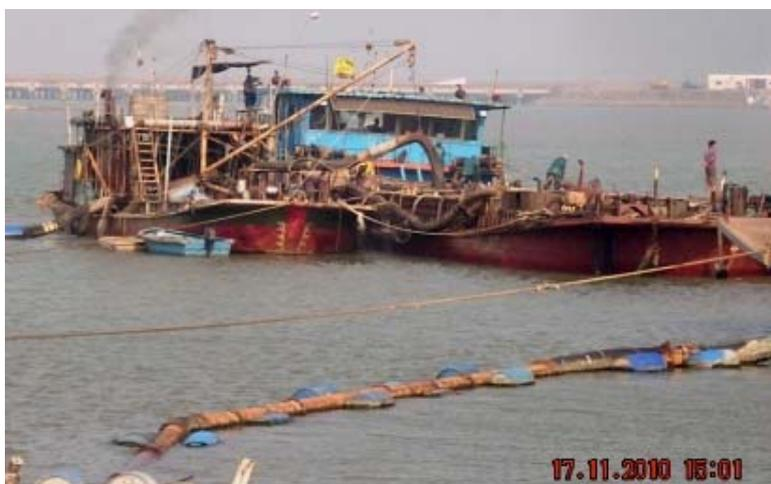
Fig. 4.2 - Barcaças de carga de areia e com bombas
