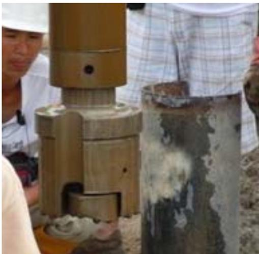
Fig. 4.16– Cabeça da broca para escavação
