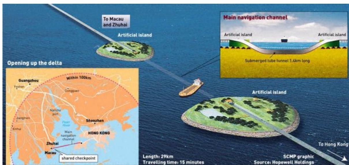
Fig. 6.7 – Mapa de localização da Ligação Macau-Zhuhai –Hong Kong e modelo da ligação em túnel, adaptado de [39,40]
