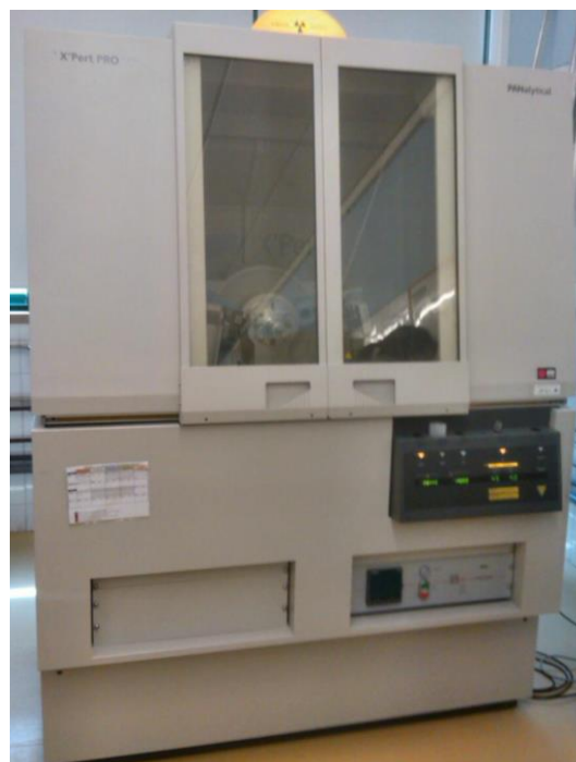
Figura 7 Equipamento utilizado na difração de raios X ( PANalytical X'pert Pro ).
