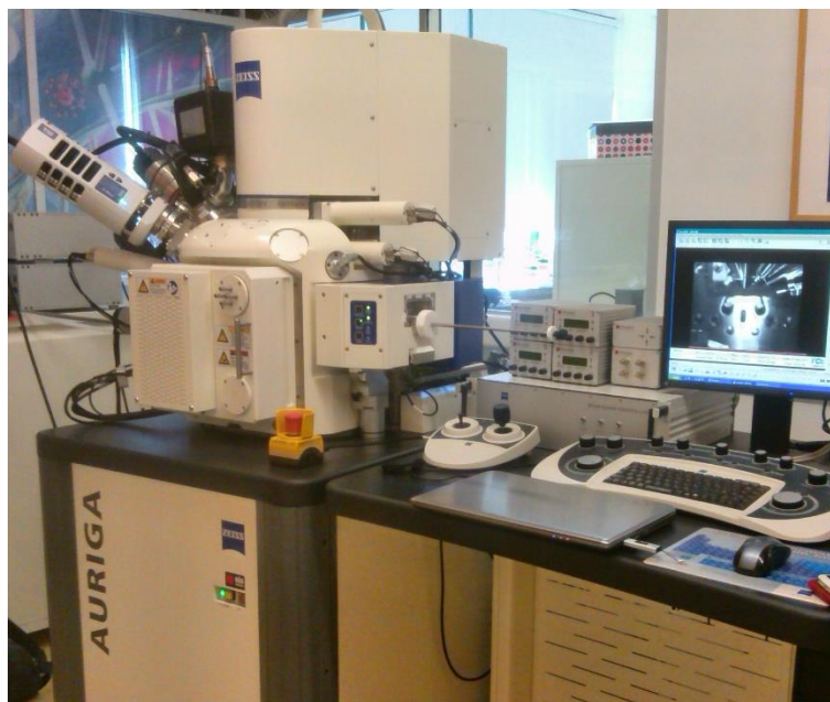
Figura 6 Equipamento utilizado em microscopia eletrônica de varrimento ( Carl Zeiss AURIGA Crossbeam SEM-FIB ).
