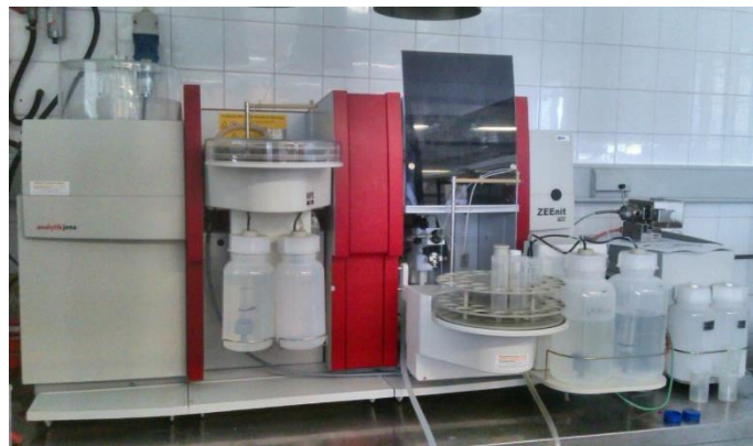
Figura 8 Equipamento utilizado na espectroscopia de absorção atômica de chama de acetileno/ar ( Analytik Jena - Zeenit 700 ).
