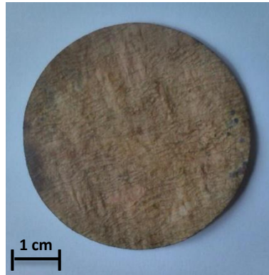
Figura 21 Filtro de celulose impregnado com nanopartículas de óxido de zinco e de prata (ZnO+Ag).
