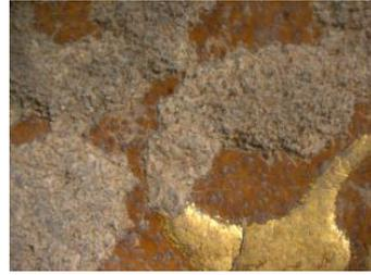
b) Pormenor do destacamento da flor da pele e do douramento na frente da encadernação, ampliação de 7x.
