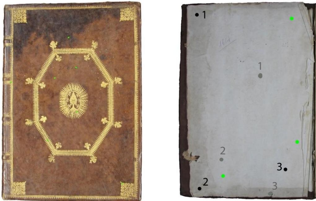
Fig. XXVII: Mapeamento das análises: frente da encadernação e guarda colada da frente; μ-EDXRF (●), pH (●), colorimetria (●).
