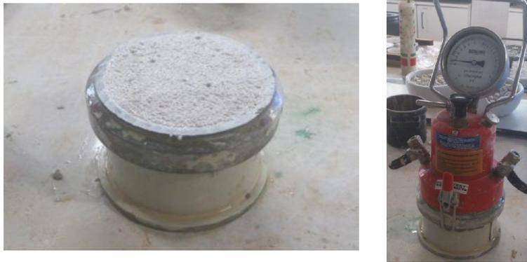
**Figura 3.2** - Copo com argamassa no estado fresco e equipamento para determinação do teor de ar
