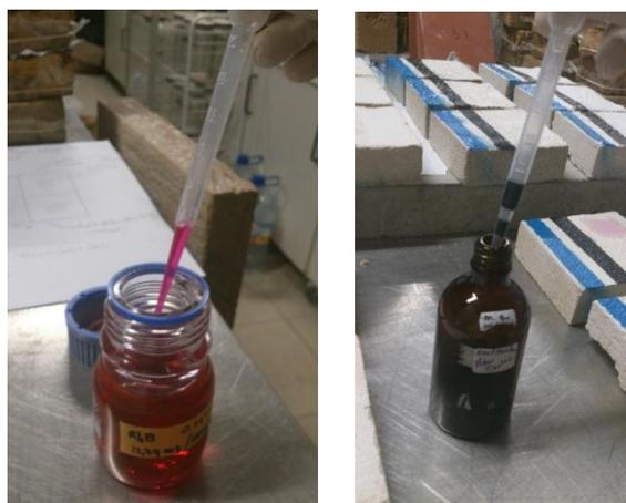
**Figura 3.18 - Aplicação dos corantes nos provetes**
