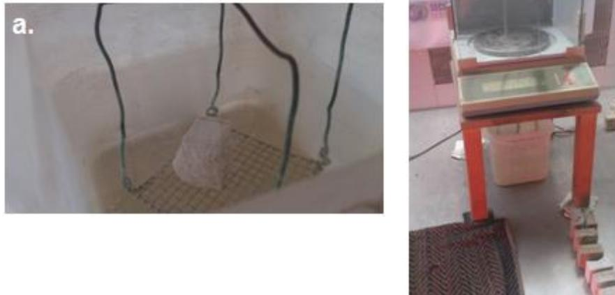
**Figura 3.10 - Pesagem hidrostática e saturada**
