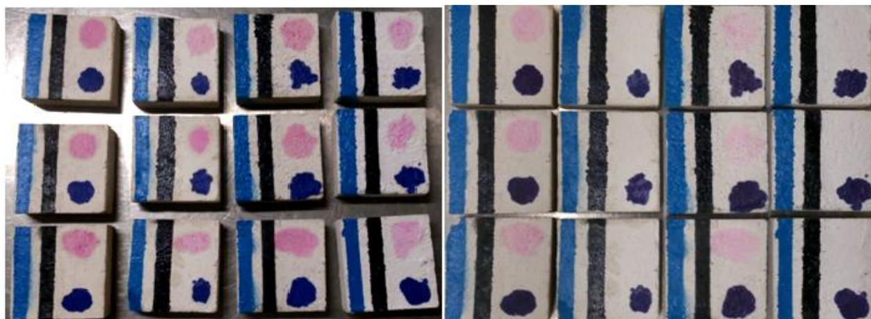
**Figura 4.19** - Alteração de cor dos provetes de argamassa entre 0h e 1176h após exposição de luz UV
