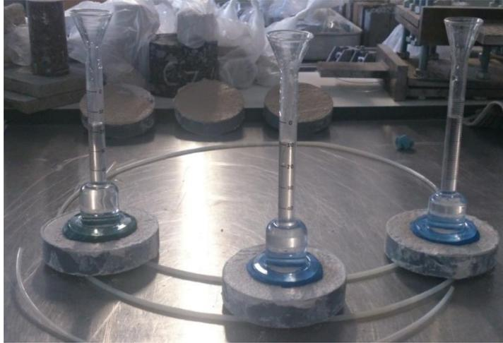
**Figura 3.13** - Ensaio de absorção de água sob baixa pressão
