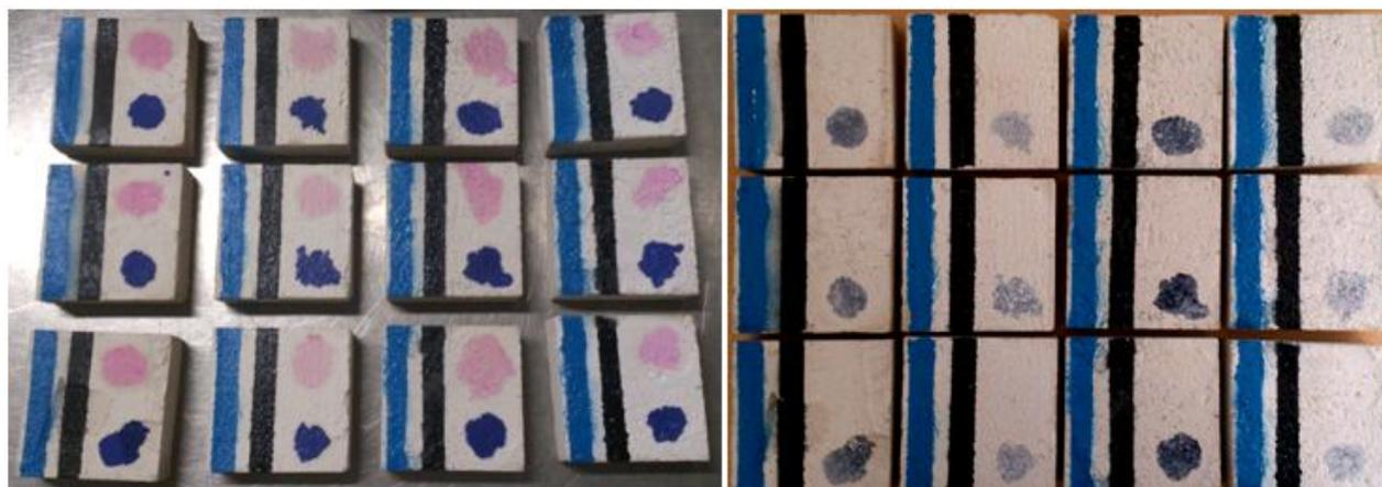
**Figura 4.18** - Alteração de cor dos provetes de argamassa entre 0h e 586h após exposição de luz solar
