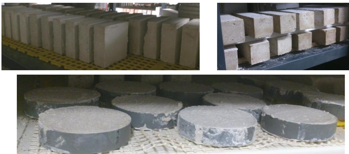
**Figura 3.5** - Provetes em condições de cura standard na sala climatizada
