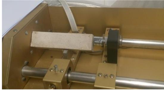
**Figura 3.6** - Provete em ensaio no equipamento “ZEUS Resonance Meter”
