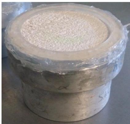
**Figura 3.14** - Conjunto cápsula e provete
