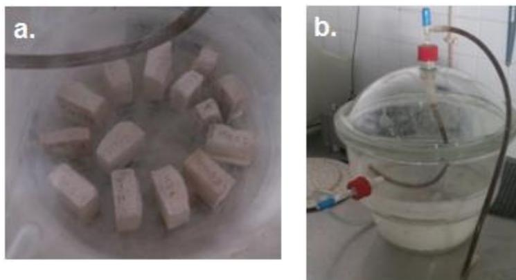
**Figura 3.9** - Ensaio de porosidade aberta, amostras em vácuo
