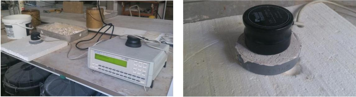
**Figura 3.8** - Realização do ensaio de medição da condutibilidade térmica
