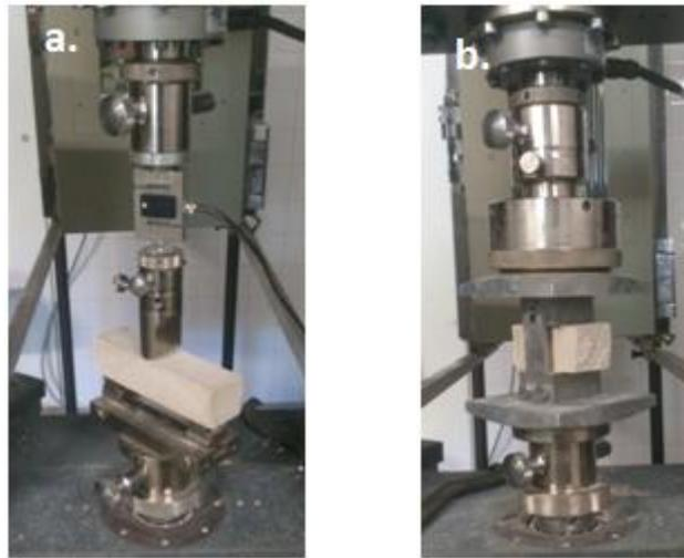
**Figura 3.7** - Provete ensaiado à tracção por flexão e à compressão
