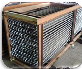
Figura 10.1 - Exemplo de um economizador tubular [44]
