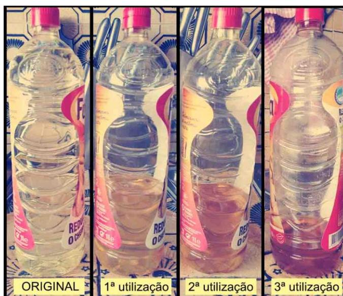
Figura 3.6 – Reutilização do óleo durante três dias de medições por equipamento.
