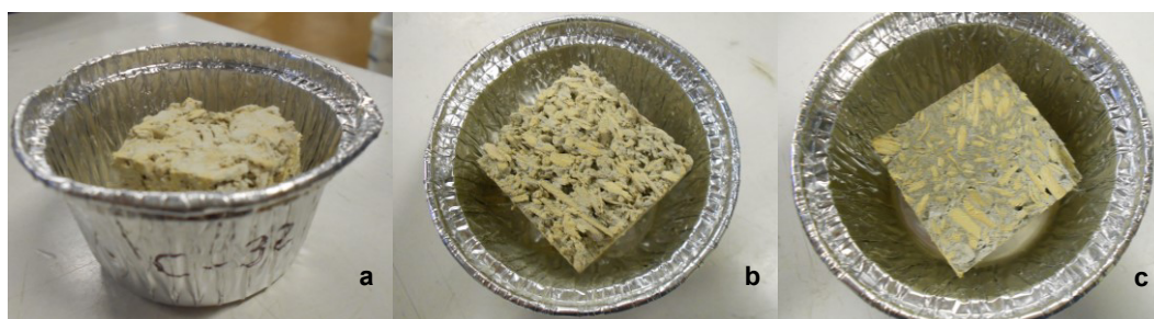
Figura 1: Exemplo de amostras dos betões utilizadas no ensaio de adsorção isotérmica (a - Calco; b - PF70; c - NL)
