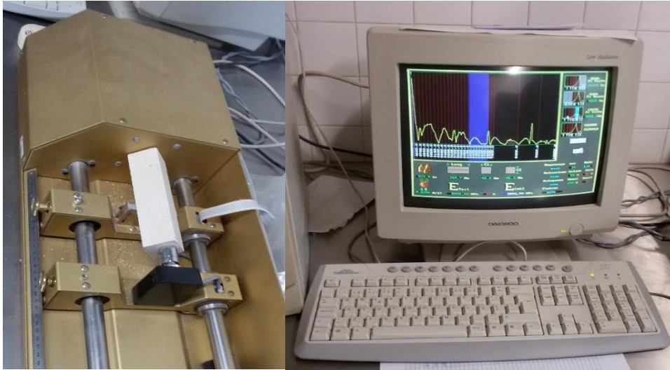
Figura 3.3 – Equipamento necessário para a realização do MED: “Zeus Resonance Meter”
