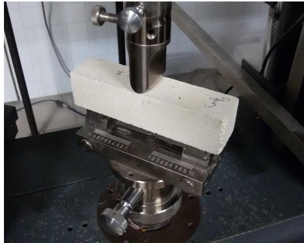
Figura 3.4 - Ensaio de resistência à tração por flexão
