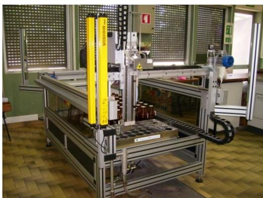
Figura 4.4 Máquina de pipetar / doseadora utilizada na preparação dos copos de tingimento
