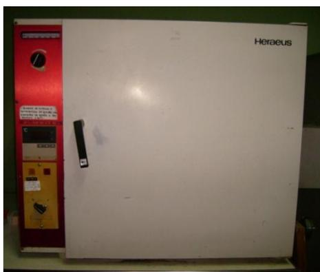
Figura 4.9 Estufa utilizada para a secagem das amostras tingidas
