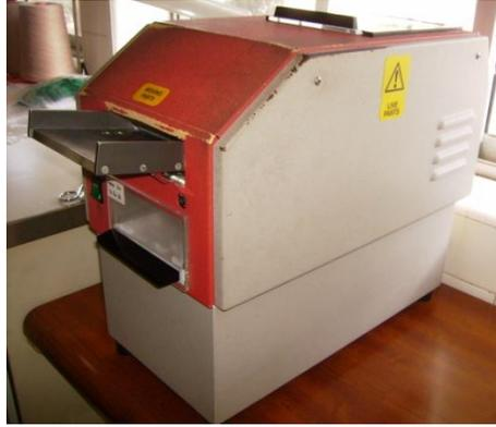
**Figura 4.10** Carda utilizadas nas amostras tingidas
