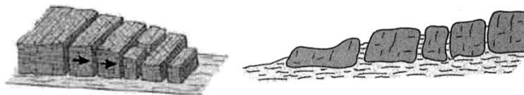
Figura 2.8 – Representação esquemática: expansão lateral (adaptado de Vallejo et al. , 2004)
