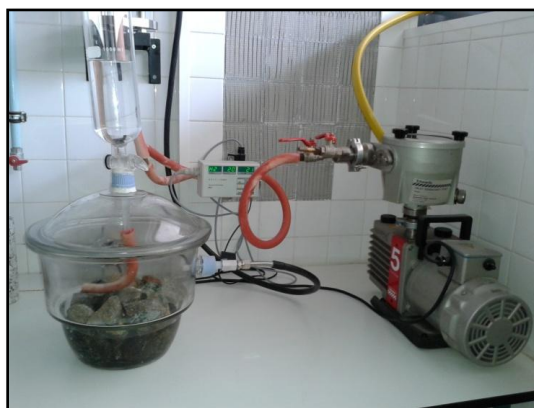
Figura 3.5 – Bomba de vácuo para período de absorção de água
