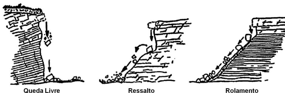
Figura 2.1 – Representação esquemática: trajetórias de quedas (traduzido de Ayala Carcedo, 1987)
