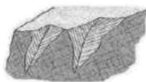
Figura 2.7 – Representação esquemática: escorregamentos translacionais (Vallejo et al. , 2004)
