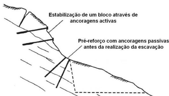
Figura 4.9 – Representação esquemática: utilização de ancoragens activas e passivas (traduzido de Wyllie & Mah, 2004)
