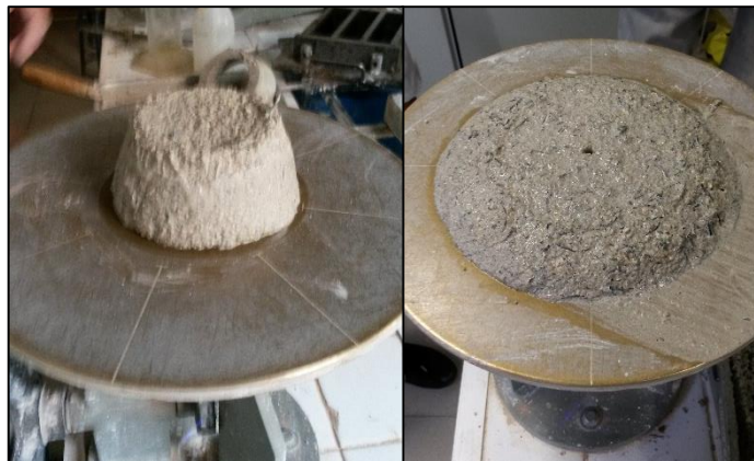
Figura 3.6 - Ensaio de espalhamento da argamassa antes e após as 15 pancadas da mesa de espalhamento
