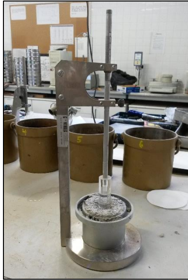
Figura 3.7 - Ensaio de consistência por penetrómetro da argamassa
