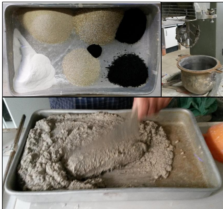
Figura 3.5 - Agregados constituintes da argamassa no estado seco (em cima à esq.); cuba misturadora (em cima à dir.); homogeneização da argamassa fresca (em baixo)
