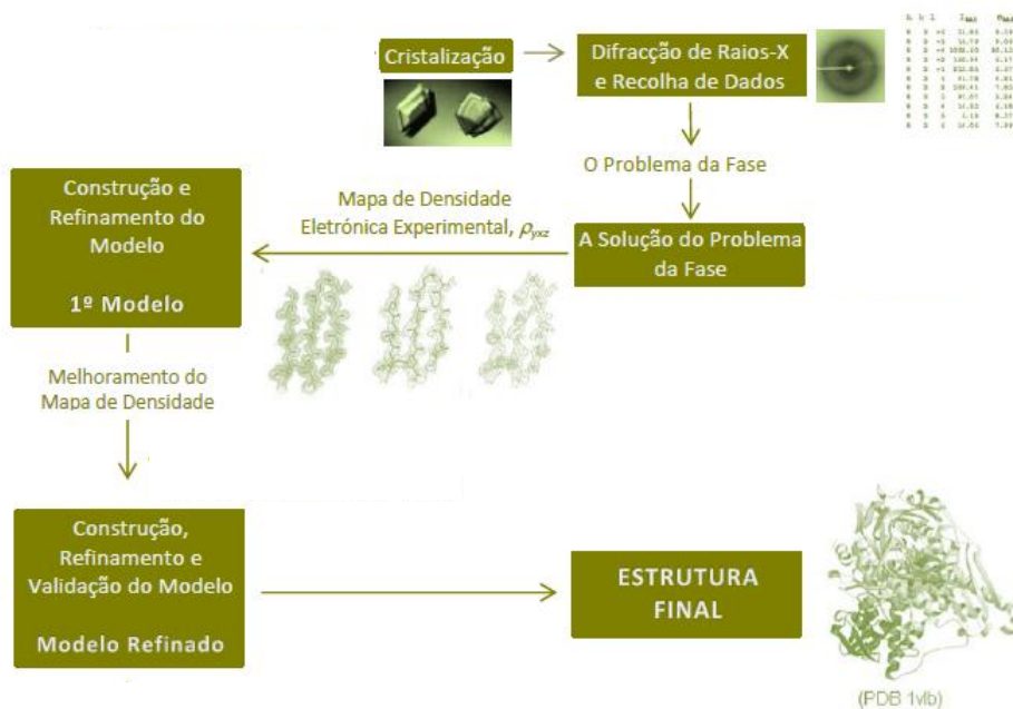
Figura 1.7 – Principais etapas envolvidas no método de Cristalografia de raios-X para determinação de estruturas tridimensionais de macromoléculas. (Adaptado de (Carvalho et al. 2009)).
