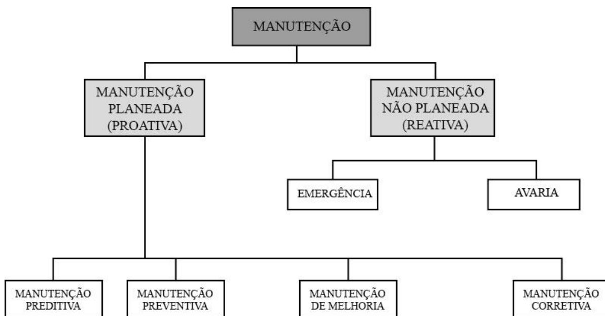
Figura 2.2 - Visão geral da manutenção
