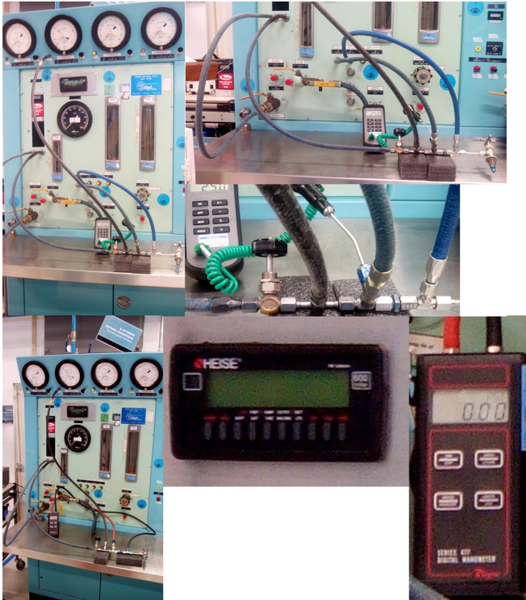
Figura 4.7 - Manómetros de pressão analisados no banco de ensaio
