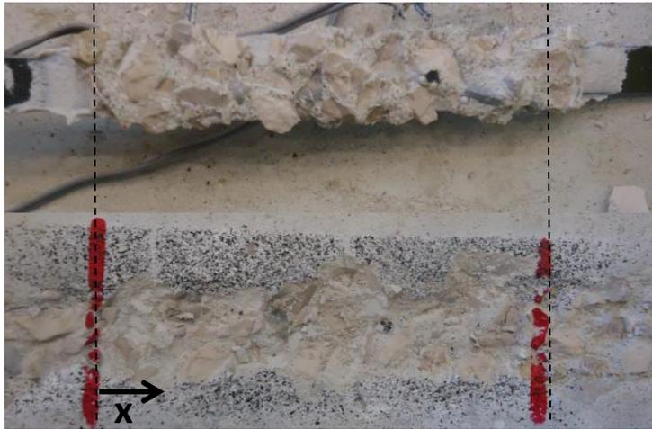
**Figura 4.16** - Modo de rotura da amostra EBR\_100\_01.
