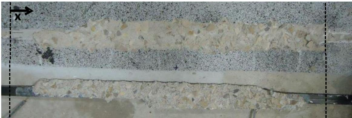
**Figura 4.6** – Modo de rotura da amostra EBR\_300\_01.
