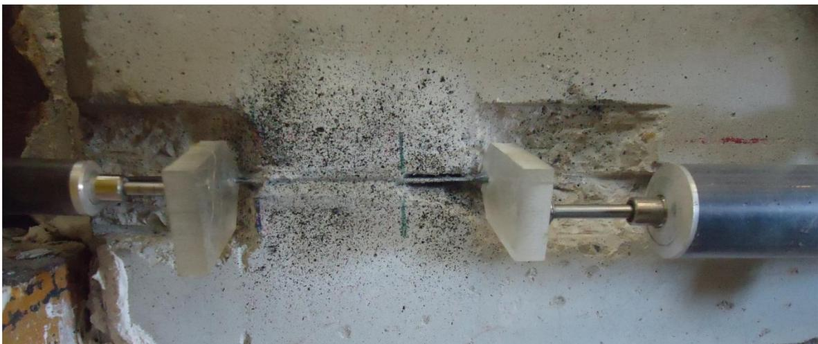
**Figura 3.17** – Pormenor da localização dos transdutores de deslizamento.
