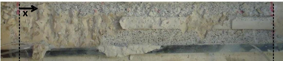
**Figura 4.8** - Modo de rotura da amostra EBR\_300\_03.
