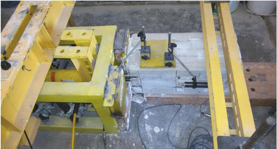
**Figura 3.16** – Configuração do sistema de ensaio para a técnica NSM.
