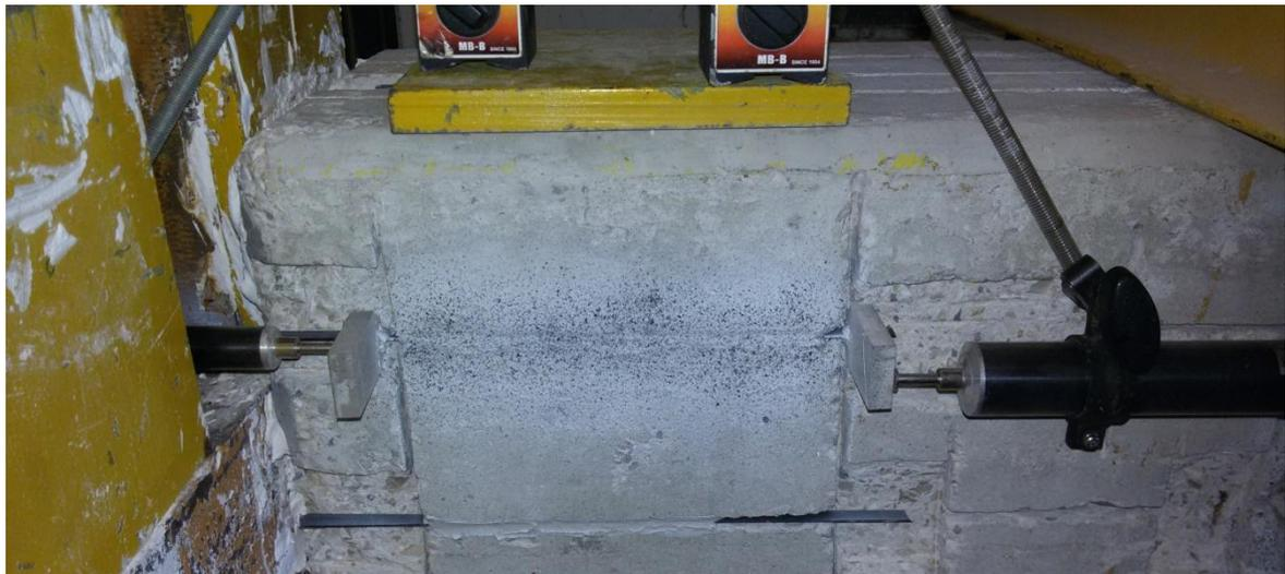
Figura 4.28 - Localização dos transdutores de deslizamento, LVDT1 e LVDT2.
