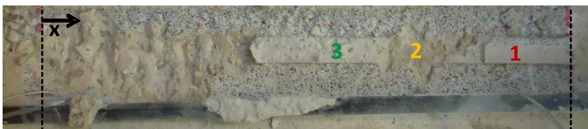
**Figura 4.5** – Modo de rotura do ensaio EBR\_300\_03 e identificação dos pontos 1 e 2.
