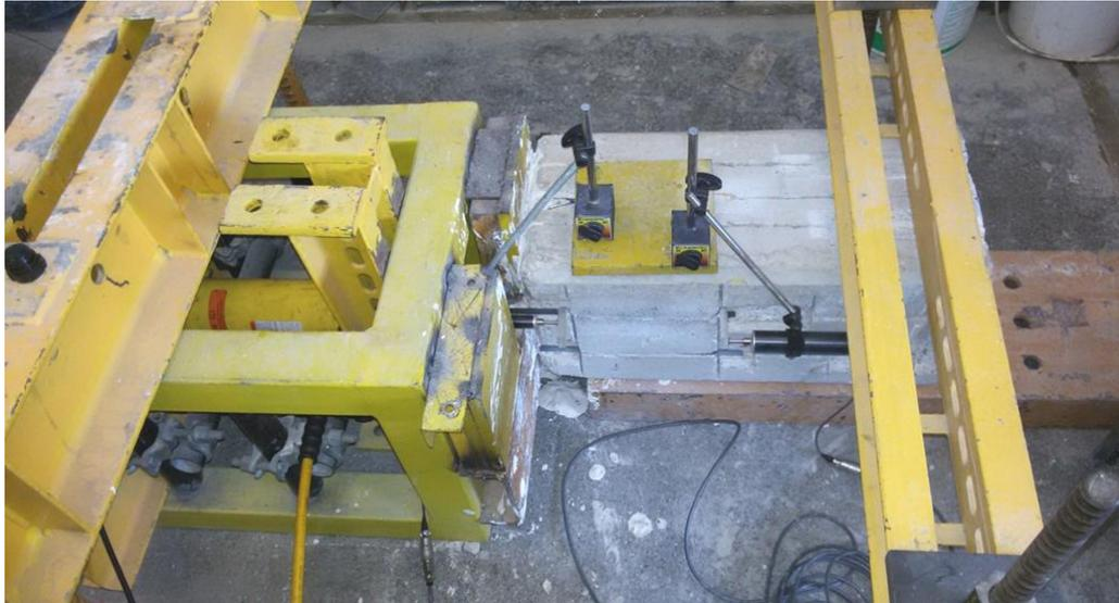
**Figura 4.26** – Configuração final do sistema de ensaio para a técnica NSM.
