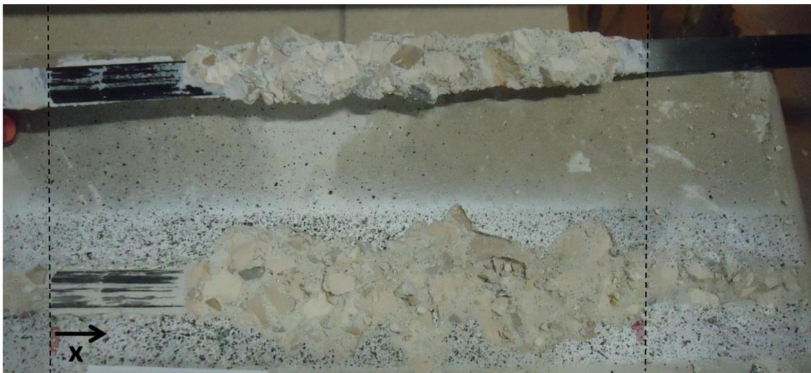
**Figura 4.13** – Modo de rotura da amostra EBR\_150\_01.
