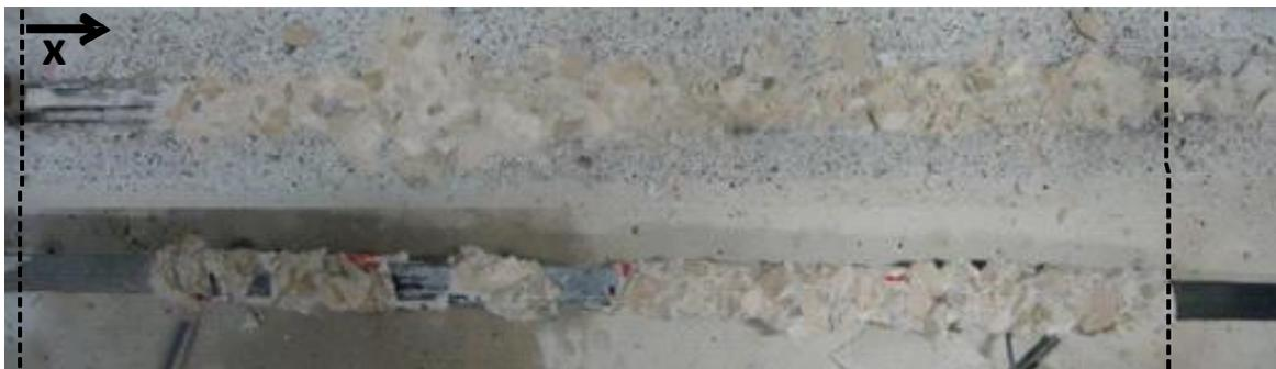
**Figura 4.7** - Modo de rotura da amostra EBR\_300\_02.
