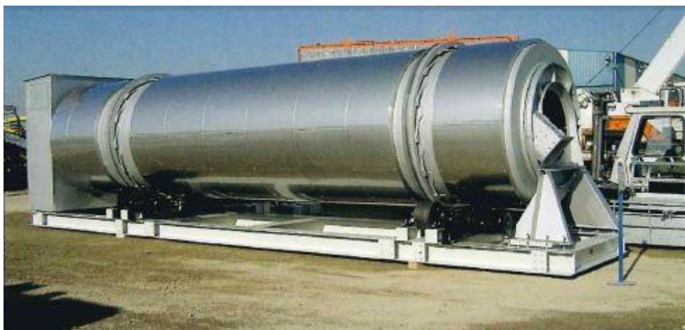
Figura 5.17 - Tambor rotativo para arrefecimento de areias (KTI, 2011)
