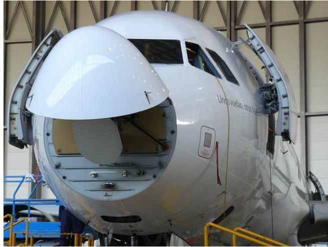
Figura 3: Airbus A320, com destaque para o radome e a antena localizada no seu interior [10].
