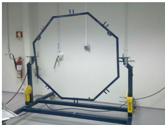
Figura 8: Suporte para reparação de radomes.
