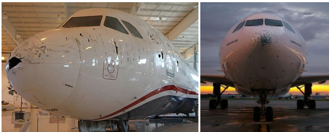
Figura 6: Na foto à esquerda, a foto do Airbus A320 da US Airways que em 2009 sofreu um bird strike e que foi obrigado a uma aterragem forçada no Rio Hudson, em Nova Iorque [16]; À direita, é possível perceber os danos sofridos no radome depois de uma aeronave ser atingida por uma tempestade de granizo em pleno voo [17].
