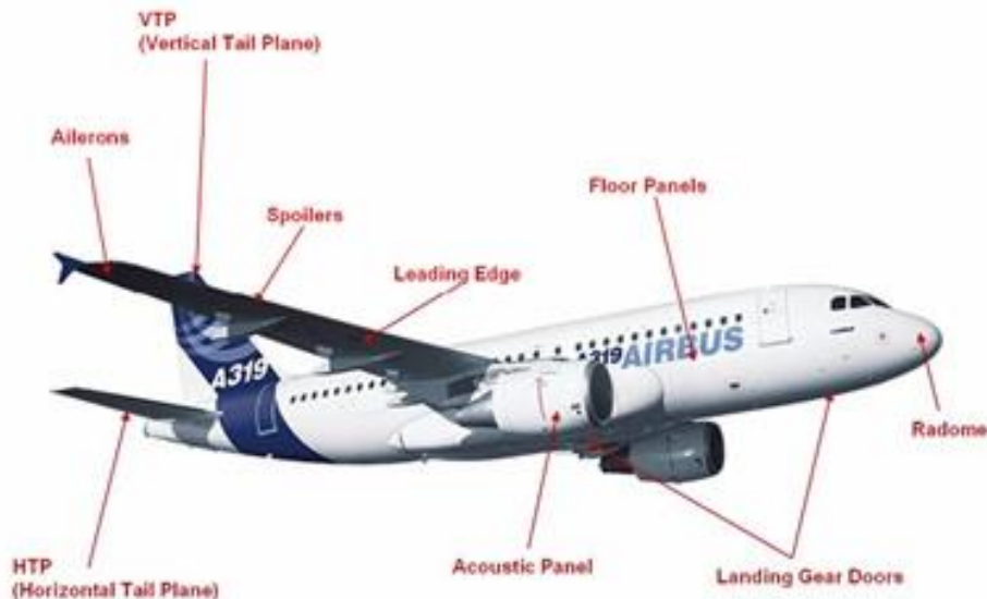
Figura 2: Principais componentes fabricados em compósitos de uma aeronave da família AIRBUS A320, adaptado de [3].
