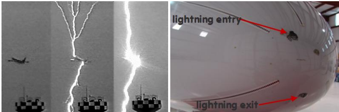
Figura 7: À esquerda é possível ver uma sequência de fotos de uma aeronave a ser atingida na frente por um relâmpago no radome, descarregando depois o relâmpago pela cauda em direcção à Terra [19]; À direita, é possível perceber os orifícios de entrada e de saída num radome atingido por um relâmpago [20].
