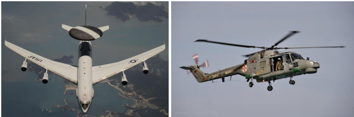
Figura 4: À esquerda, radome instalado no topo da fuselagem de um avião militar utilizado para vigilância aérea [11]; Na foto da direita, radome instalado por baixo do nariz de um helicóptero militar [12].
