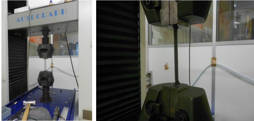
Figura 14: À esquerda, vista geral da zona de testes da Máquina Universal de Ensaios Mecânicos Shimadzu AG50 kNG; À direita, pormenor de um provete a ser ensaiado à tracção.
