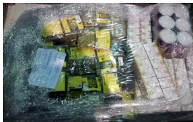
Figura 4. 9 - Exemplo de má paletização provocada pelo tipo de embalagens dos produtos
