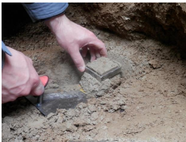
Figura 4.20 - Recolha de amostra indeformada, com caixa de corte, na zona a NW do Vanzinho (amostra AM2) (11/04/2014)
