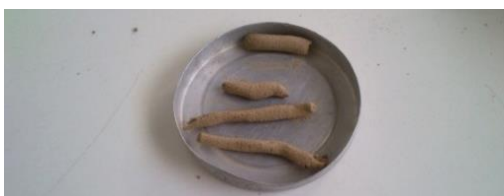
Figura 3.44 - Pequenos filamentos cilíndricos para determinação do Limite de Plasticidade
