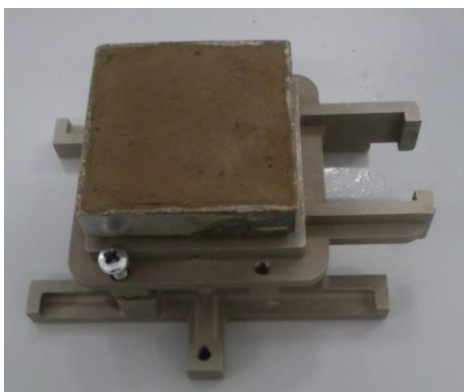
Figura 4.30 - Amostra AM2 na caixa de corte antes da realização do ensaio de corte direto (24/06/2014)
