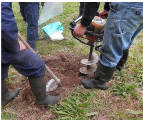
Figura 4.21 - Recolha de amostra remexida com trado mecânico, na zona a NW do Vanzinho (amostra T2) (11/04/2014)
