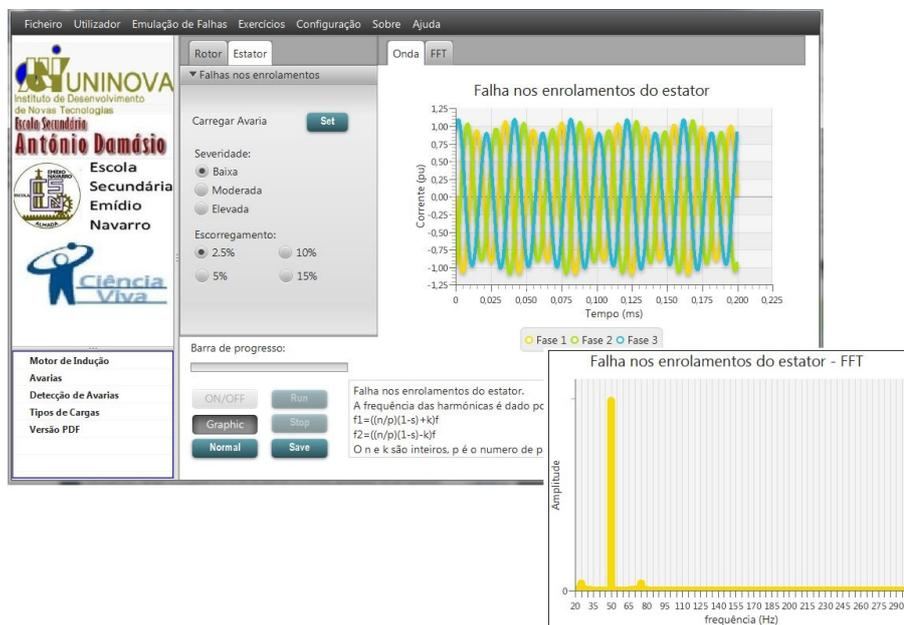
Figura 5.10: Simulação da avaria nos enrolamentos do estator com severidade baixa e escorregamento igual a 2.5%.
