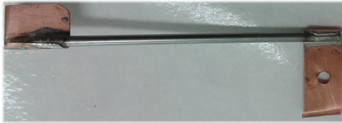
Figura 5.9: Tubo de inox com chapas de cobre.
