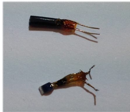
Figura 3.1: Resistências Pt 100 \Omega com (em cima) e sem (em baixo) stycast ® .
