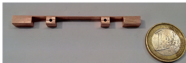
Figura 3.10: Amostra de cobre de controlo onde são visíveis os furos para alojar as resistências Pt 100 \Omega .
