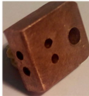
Figura 3.3: Peça para calibração das resistências de platina.
