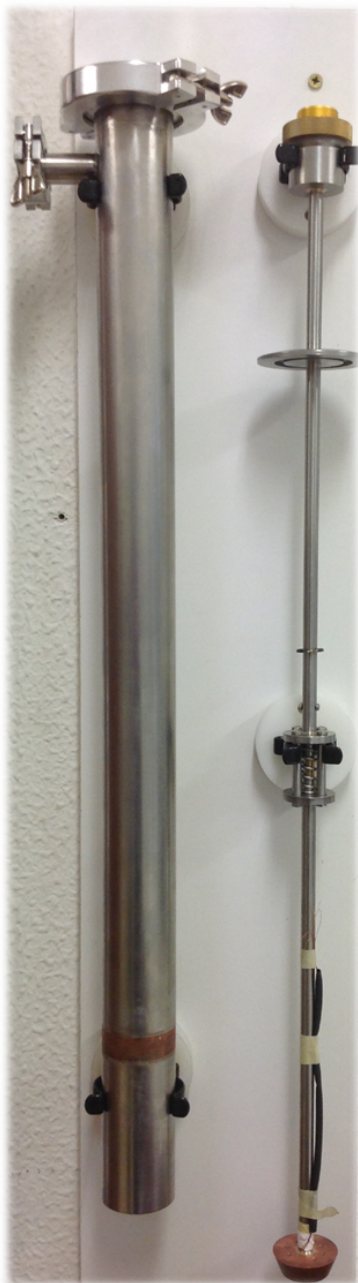
Figura 5.6: Parte externa e insert do criostato.
