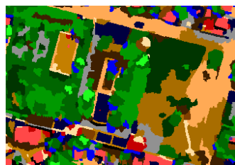
Parâmetros utilizados: Gamma in Kernel Function = 0,1 Penalty Parameter = 100 Atributos espectrais e de textura: - bandas diferentemente distribuídas Atributos de forma: - Elongation e Form Factor
