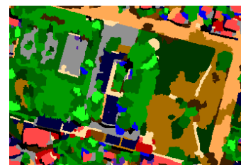
Parâmetros utilizados: Gamma in Kernel Function = 0,9 Penalty Parameter = 100 Atributos espectrais e de textura: - bandas diferentemente distribuídas Atributos de forma: - Elongation e Form Factor
