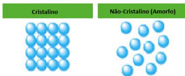
**Figura 3.9-Estrutura atômica de um material Cristalino e de um material não-cristalino**
