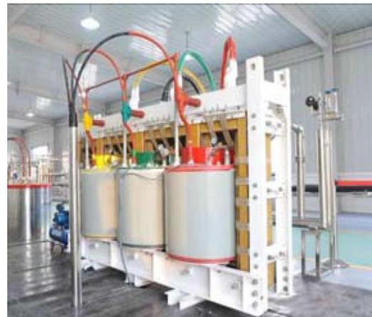
**Figura 2.1- Transformador trifásico supercondutor de núcleo amorfo de 630 kVA.**
