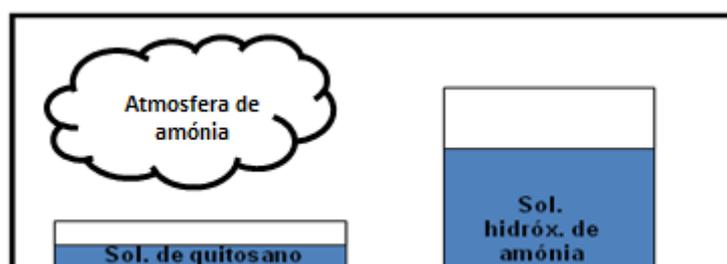
Figura 3.30- Esquema da câmara de amónia utilizada para a produção de hidrogéis de quitosano
