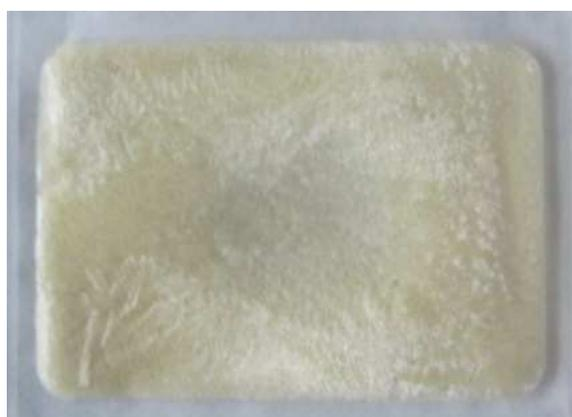
Figura 4.4 – Fotografia de uma matriz de quitosano liofilizada produzida a partir de uma solução de concentração 3% (m/v) em ácido acético
