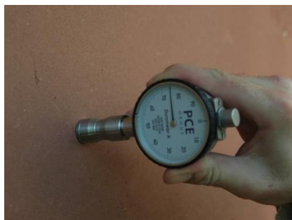
Figura 8.40 – Ensaio de dureza superficial por durómetro Shore A no reboco sobre um murete
