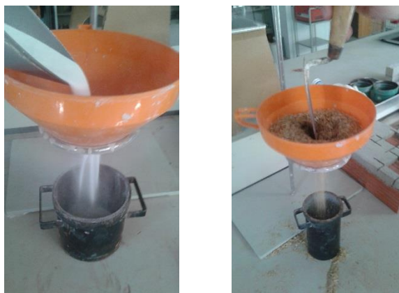
Figura 9.1 – Ensaio de baridade dos PCM (à esq.); Ensaio de baridade das fibras vegetais (à dir.)
