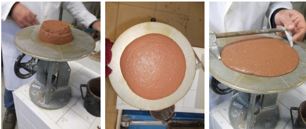
Figura 8.6 – a) Aspeto da argamassa de terra sobre a mesa de espalhamento; b) Aspeto da argamassa após as 15 pancadas da mesa de espalhamento; c) Medição do espalhamento
