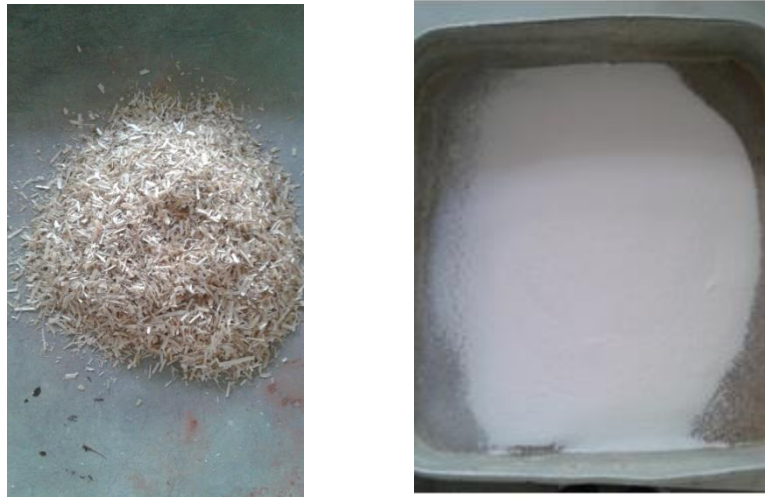
Figura 7.4 – Fibras vegetais de palha de aveia cortada (à esq.) e PCM utilizados (à dir.)
