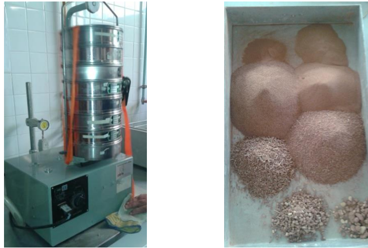
Figura 8.4 – Peneiros de malha quadrada e máquina de vibração horizontal (à esq.); Amostra recolhida em cada peneiro (à dir.)
