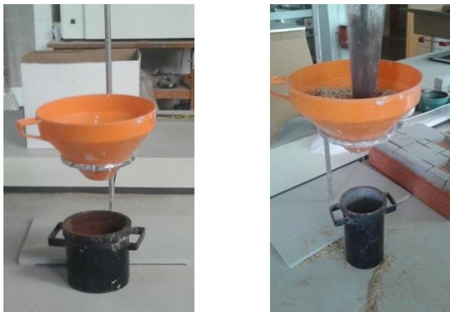
Figura 8.3 – Material necessário para o ensaio de baridade (à esq.); Ensaio de baridade à argamassa pré-doseada (à dir.)
