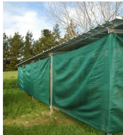
Figura 7.6 – Muretes de alvenaria de tijolo furado, de adobe, de blocos de betão e de pedra argamassada (da esquerda para a direita) (à esq.) [Faria et al., 2014]; Proteção dos muretes vista pela fachada Sul (à dir.) [Faria et al., 2014]
