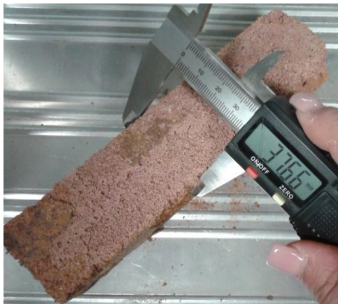
Figura 8.13 – Medição das dimensões dos provetes prismáticos
