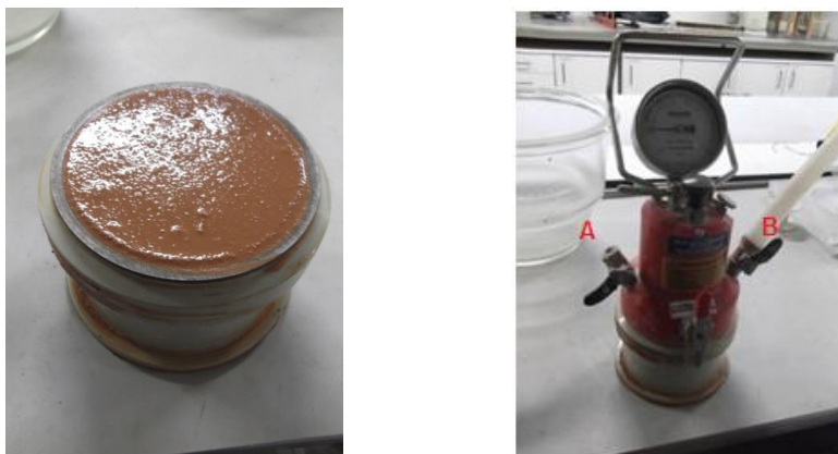
Figura 8.7 – Aspeto da argamassa no recipiente próprio para o ensaio de teor de ar (à esq.); Equipamento para determinação do teor de ar (à dir.)
