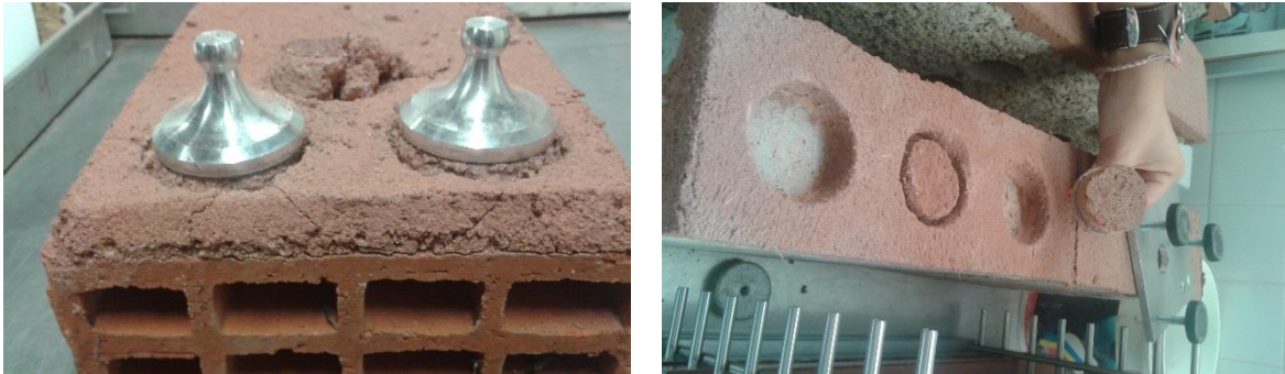
Figura 9.21 – Ensaio de aderência ao suporte no provete de argamassa sobre o tijolo (à esq.); Ensaio de aderência ao suporte no provete de argamassa sobre o bloco de betão (à dir.)
