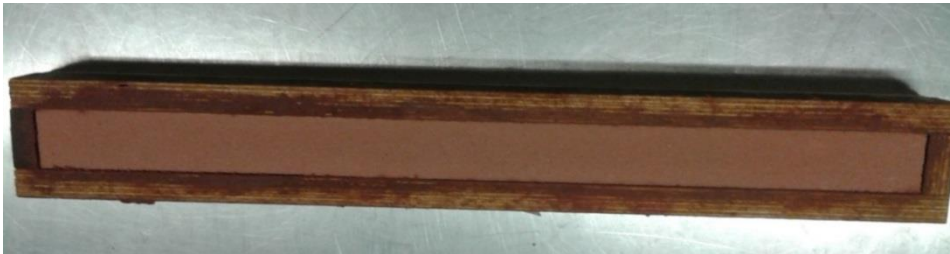
Figura 8.10 – Caixa de contraplacado marítimo com o provete de argamassa de terra
