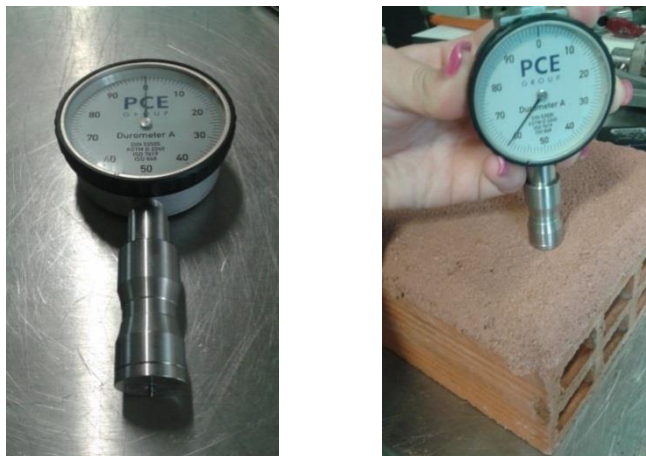
Figura 8.34 – Durómetro Shore A, PCE Group (à esq.); Ensaio de dureza superficial (à dir.)
