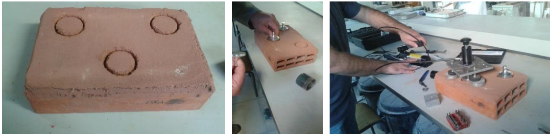
Figura 8.37 – Corte da área de ensaio sobre o tijolo (à esq.); Aplicação das pastilhas metálicas de 50 mm de diâmetro sobre a argamassa (ao centro); Ensaio de aderência ao suporte sobre o tijolo (à dir.)
