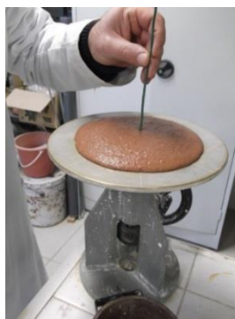
Figura 8.11 – Ensaio de abaixamento
