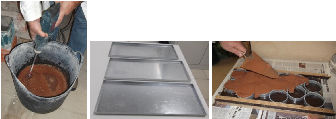
Figura 7.8 – Mistura em laboratório da argamassa pré-doseada (à esq.); Molde de 500x200x15 [mm] em aço inoxidável (ao centro); Preparação dos provetes circulares de 90 mm de diâmetro e 15 mm e 2 mm de espessura (à dir.)
