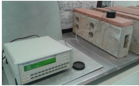
Figura 9.16 – Ensaio de condutibilidade térmica sobre os blocos de betão
