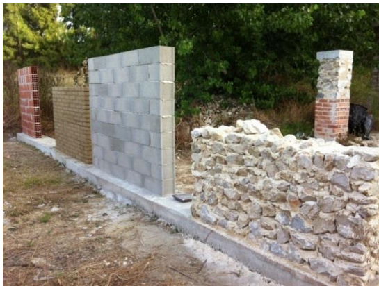
Figura 7.6 – Muretes de alvenaria de tijolo furado, de adobe, de blocos de betão e de pedra argamassada (da esquerda para a direita) (à esq.) [Faria et al., 2014]; Proteção dos muretes vista pela fachada Sul (à dir.) [Faria et al., 2014]
