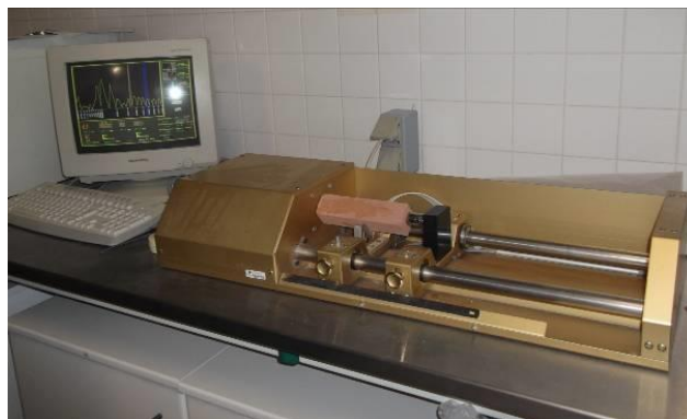
Figura 8.16 – Equipamento “ZEUS Resonance Meter” e provete em ensaio
