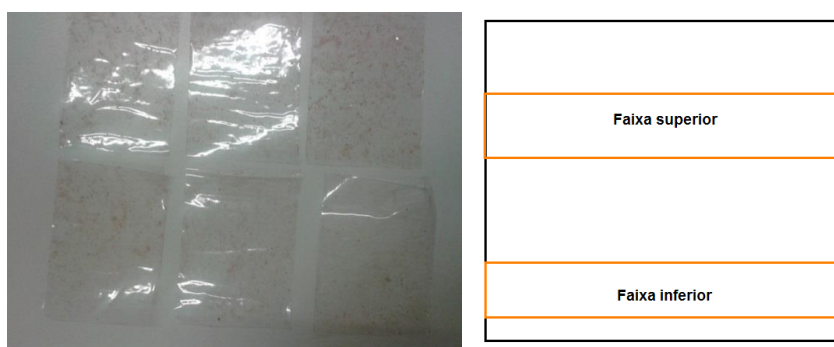
Figura 8.46 – Fita adesiva com o material retido (à esq.); Mapeamento das zonas de ensaio (à dir.)
