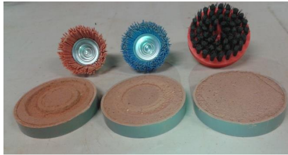
Figura 8.53 – Efeito de cada escova nos provetes circulares
