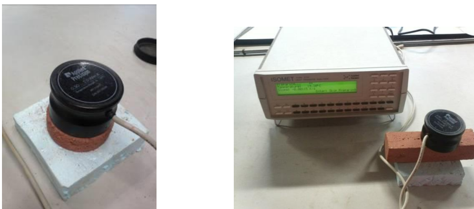
Figura 8.14 – Ensaio de condutibilidade térmica nas bolachas de argamassas (à esq.); Equipamento ISOMET 2104 e ensaio de condutibilidade térmica nos prismas de argamassa (à dir.)
