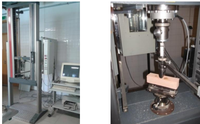
Figura 8.17 – Equipamento Zwick/Rowell Z050 (à esq.); Ensaio de resistência à tração por flexão (à dir.)
