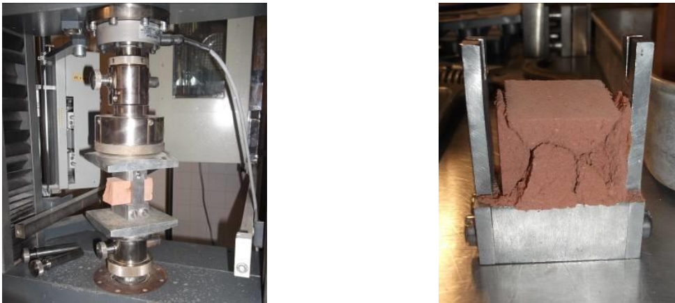
Figura 8.18 – Ensaio de Resistência à compressão (à esq.); Aspeto do provete após o ensaio de resistência à compressão (à dir.)
