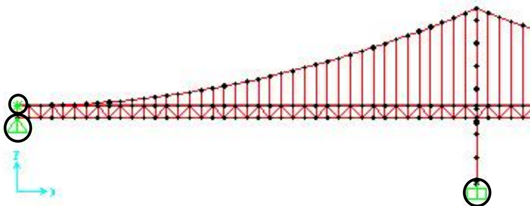
Figura 7.52 - Condições de apoio da ponte 25 de Abril.
