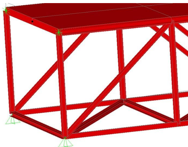
Figura 7.51 - Ligação dos pendurais, diagonais e cordas na modelação da ponte 25 de Abril.
