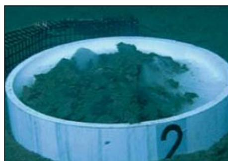
Figura 6.16 – CO<sub>2</sub> líquido colocado a 3200m de profundidade (Metz *et al.*, 2005)
