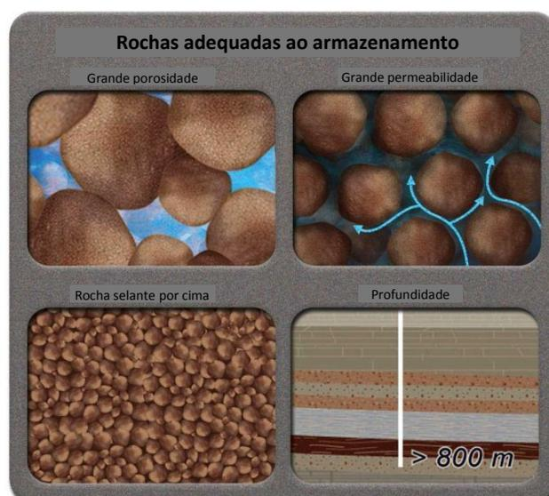
Figura 6.1 - Características das rochas onde é possível de um ponto de vista técnico armazenar geologicamente o CO<sub>2</sub> (adaptado de CO<sub>2</sub>CRC *website*)
