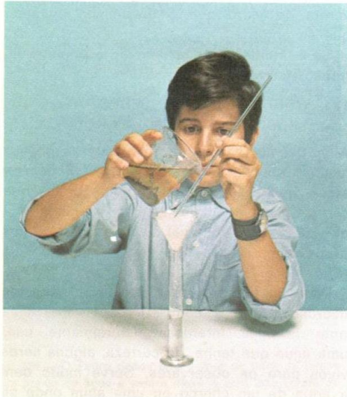
Fig. 182 — Repara bem como se filtra. O funil está enfiado numa proveta que ao mesmo tempo que o segura recolhe o líquido filtrado. O líquido do vaso onde se deitou a terra do jardim não se verte directamente para o funil. Encosta-se o bico do vaso a uma vareta de vidro e verte-se o líquido, devagar, sem nunca se encher o funil. Quando essa parcela estiver filtrada, deita-se mais. Como vêes o líquido filtrado já vem límpido. As partículas que estavam suspensas ficaram retidas no papel de filtro.
