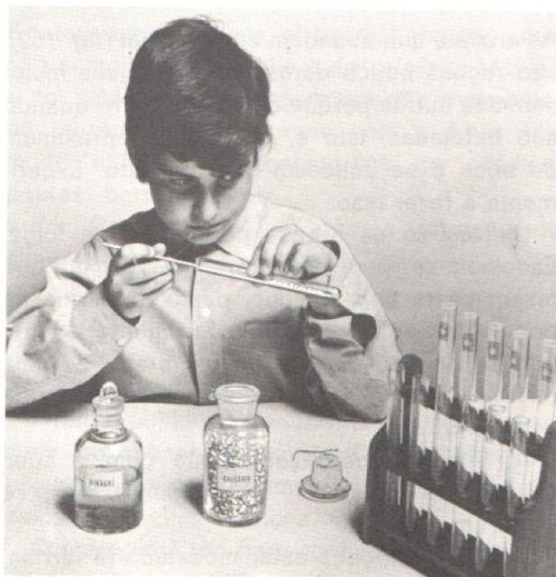
Fig. 164 — Agora o Pedro vai introduzir o calcário no tubo de ensaio. Para isso coloca o tubo quase horizontal e introduz nele a espátula até ao fundo. Feito isso põe o conjunto em posição vertical para que o calcário se instale no fundo do tubo, e retira a espátula. Os tubos de ensaio devem estar sempre bem secos.
