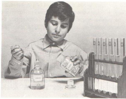
Fig. 163 — O Pedro prepara-se para experimentar a acção do vinagre sobre o calcário. A operação vai ser feita num tubo de vidro chamado tubo de ensaio . Lá está um suporte de madeira de dois andares com seis tubos de ensaio em cada andar. O Pedro começa por tirar um pouco de calcário do frasco servindo-se de uma espátula que é uma lâmina de metal, de plástico ou de vidro, estreita para caber mesmo num frasco de boca pequena, comprida para ir até ao fundo, e pouco flexível. Se a espátula tiver o fecho de uma calha côncava, melhor.
