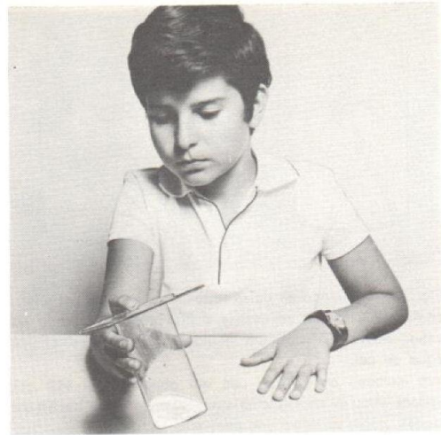
Figs. 227 e 228 — O Pedro introduziu quatro paus de fósforo, a arder, no copo com um pouco de água de cal no fundo. Quando estiver quase terminada a combustão retirará o que resta dos paus de fósforo e tapaná o copo com uma lâmina de vidro (fig. 227). De seguida agitará o copo e notará que a água de cal (que estava límpida) se torna turva (fig. 228). O que a turvou foi o dióxido de carbono resultante da combustão da madeira dos paus de fósforo.
