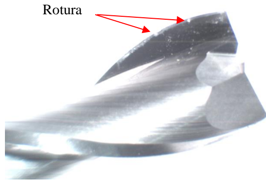
Figura 40: Segunda fresa danificada
