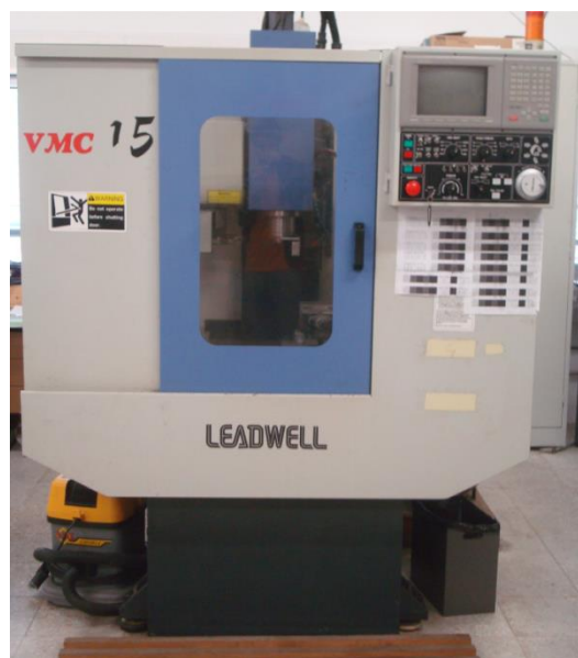
Figura 24: Centro de maquinagem do laboratório de tecnologia mecânica do DEMI (LEADWELL VMC15)
