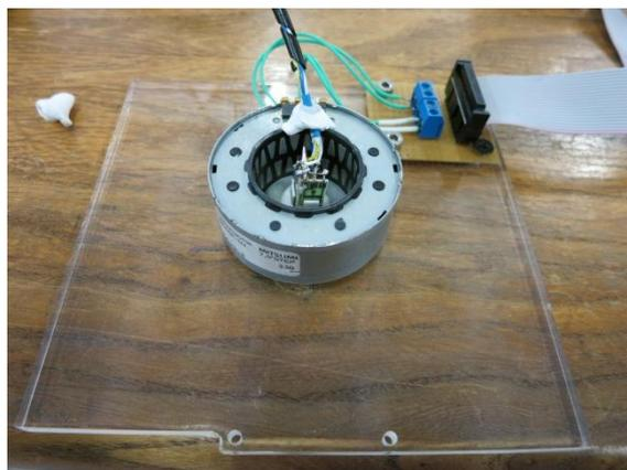
Figura 4.10 – Ensaio com sonda de Hall nº 2 no equipamento com rotação do campo magnético.
