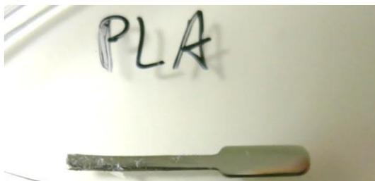
Figura 6.4 – Exemplo de um provete fornecido.
