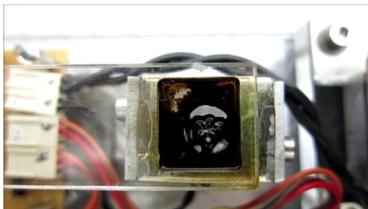
Figura 4.43 - Visualização de campo magnético com ferrofluido
