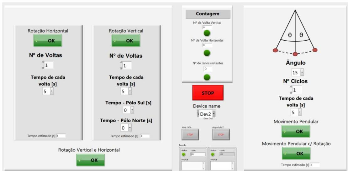
Figura 3.10 - Interface gráfica Labview™ para equipamento dedicado para aplicação de campo magnético triaxial.
