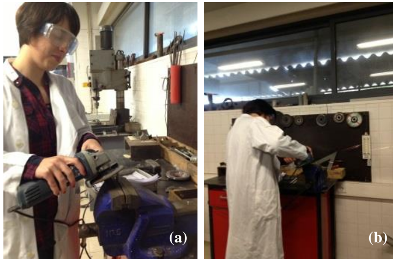
Figura 3.3 – Corte dos fios metálicos utilizados na preparação dos provetes
