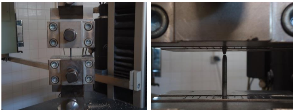
Figura 3.12 - Ensaio de tração aos fios metálicos
