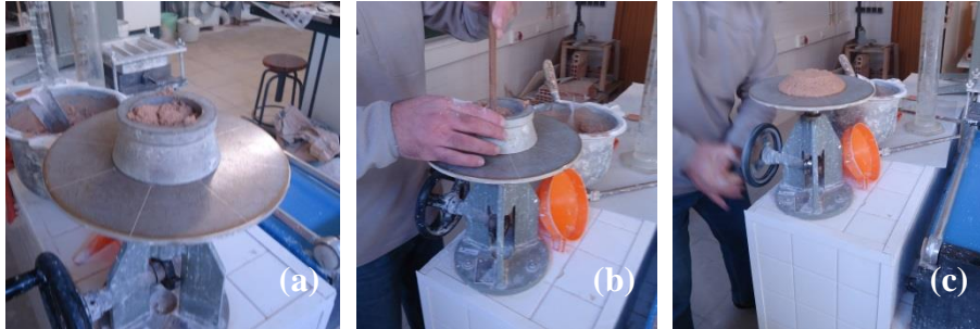
(a) - Molde tronco cônico; (b) - argamassa no molde; (c) - 15 pancadas nas camadas existentes Figura 3.7 - Sequência do ensaio de consistência por espalhamento
