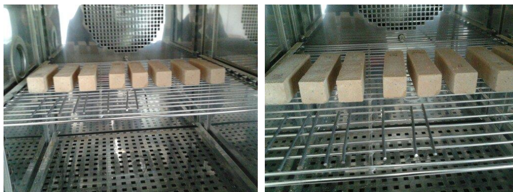
Figura 3.27 - Câmara climática usada para o ensaio aos cloretos.
