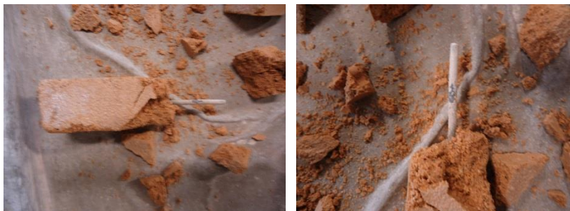
Figura 3.14 – Remoção dos fios metálicos da argamassa
