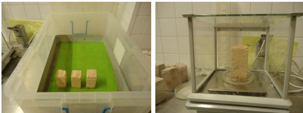
Figura 3.31 - Ensaio de absorção por capilaridade
