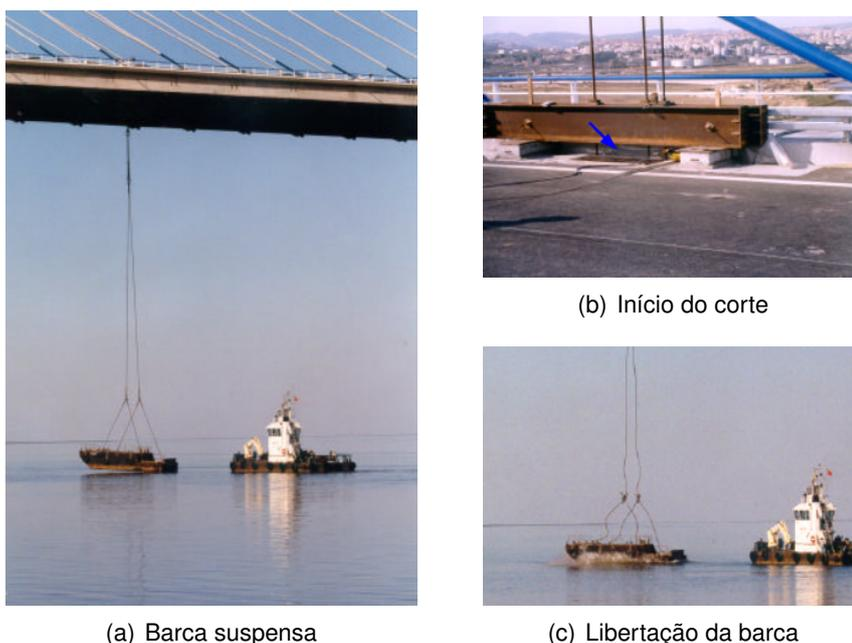
Figura 3.2: Ensaio de vibração livre [20]
