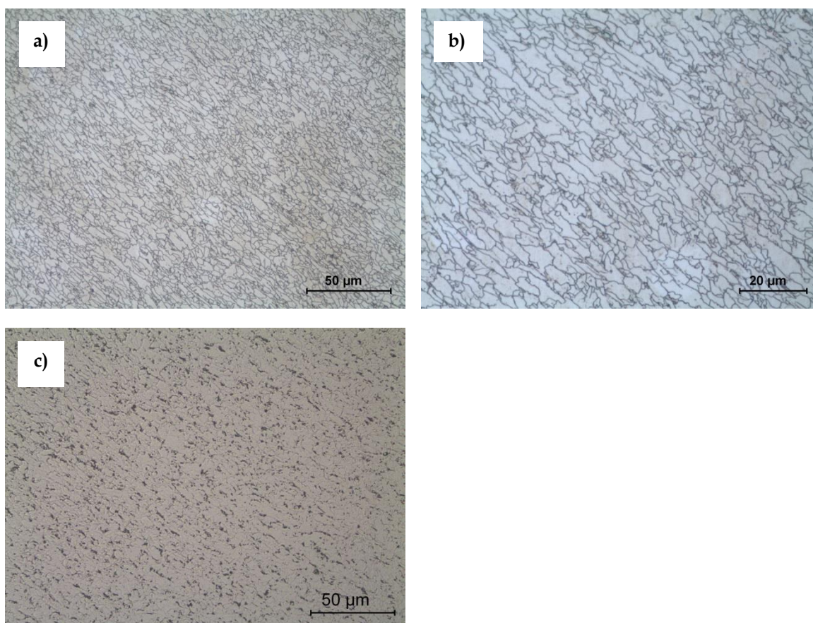
Figura 4.3 - Micrografias ópticas do material base: a) e b) contrastadas com Reagente de Marshall. c) contrastada com picral. Observadas com uma objectiva de 20x a) e c), e com uma objectiva de 50x b)
