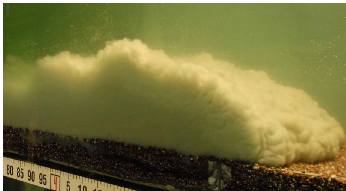
Figura 2.3: Corrente salina constante, em regime rápido, sobre um leito composto por sedimentos (Sequeiros et al., 2010).
