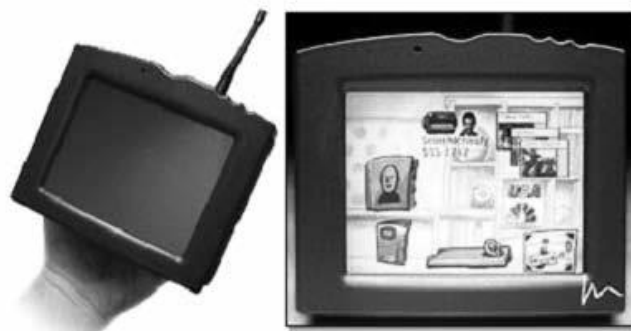
Fig.20: Controlador remoto desenvolvido *7(Star seven). [31]
