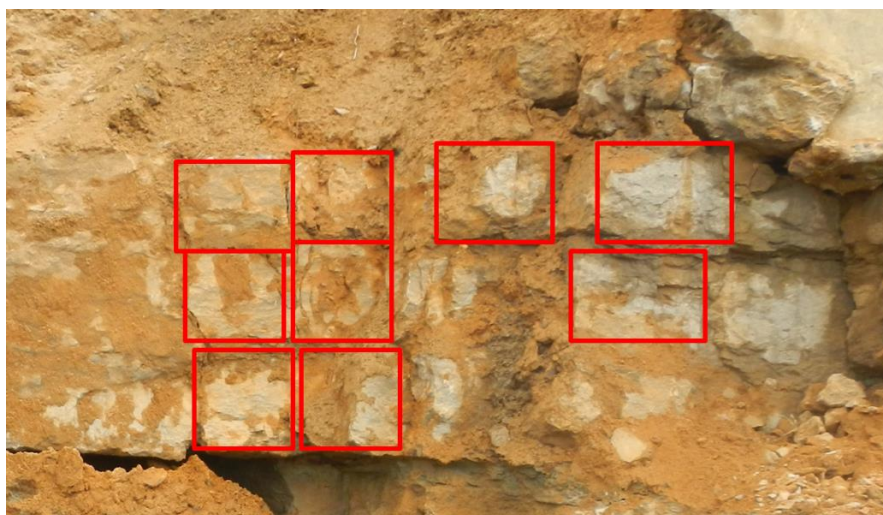
Figura 4.17: Aspecto geral da geometria dos blocos individualizados compartimentação do maciço calcário
