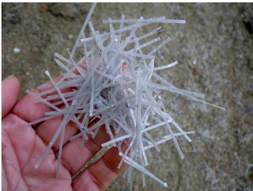
Figura 4.6: Fibras de polipropileno copolímero de alta qualidade utilizadas no betão projectado
