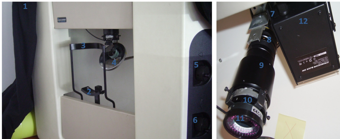
Figura 4.1 - Pupilómetro utilizado nas aquisições. Do lado esquerdo é representada a parte mecânica do pupilómetro. Do lado direito é representado todo o sistema óptico do pupilómetro. 1 - pano opaco; 2 - suporte mecânico de queixo; 3 - suporte mecânico de testa; 4 - espelho; 5 - parafuso lateral de deslocamento horizontal; 6 - parafuso lateral de deslocamento vertical; 7 - câmara; 8 - lente de zoom ; 9 - polarizador da lente; 10 - polarizador do iluminador; 11 - iluminador; 12 - estroboscópio.
