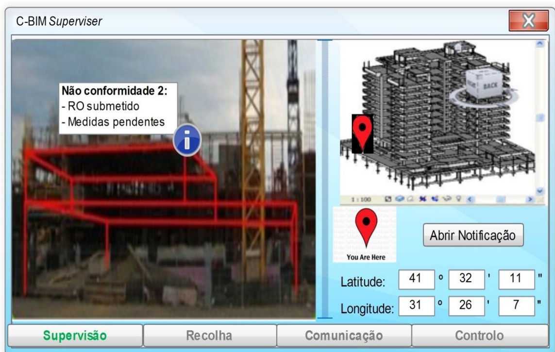
Figura 5.2 – Exemplo da interface C-BIM Supervisor a desempenhar a função de supervisão
