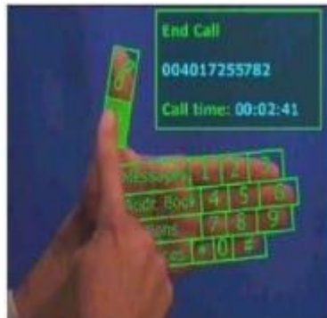
Figura 2.28 – Sistema interpreta gestos da mão e mostra um teclado virtual (Antoniac e Pulli, 2001)
