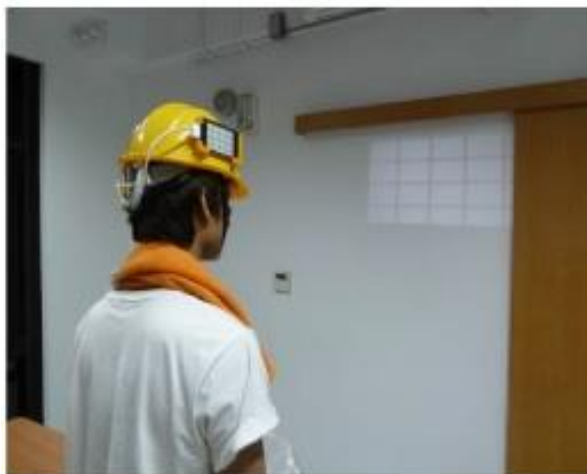
Figura 2.31 – Sistema iHelmet a projetar informação digital (Yeh et al. , 2012)
