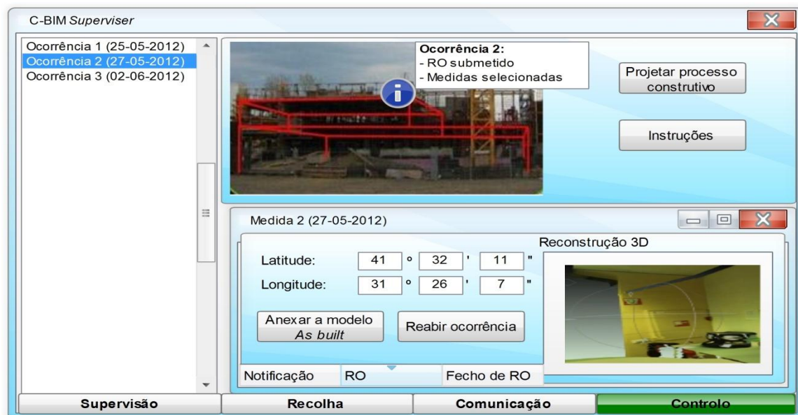
Figura 6.13 – Medidas apresentadas em obra através da interface C-BIM Supervisor
