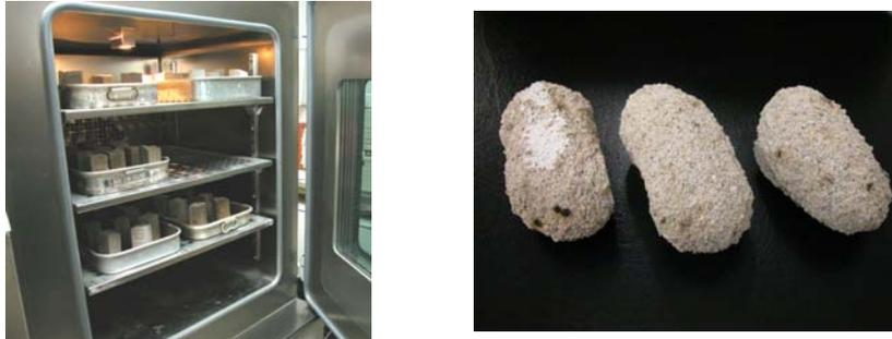
Fig. 5 – Provetes com cloretos, sujeitos a ciclos de humedecimento/secagem
