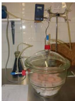
Fig. 1 – Ensaio para determinação das massa volúmica aparente e porosidade aberta
