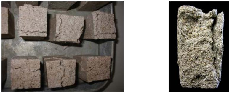
Fig. 7 – Provetes sujeitos a ataque por sulfatos
