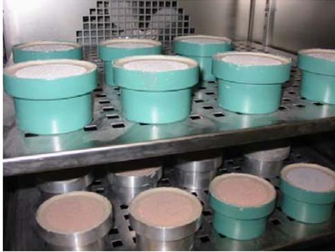
Fig. 3 – Cápsulas com provetes em ensaio na câmara climática
