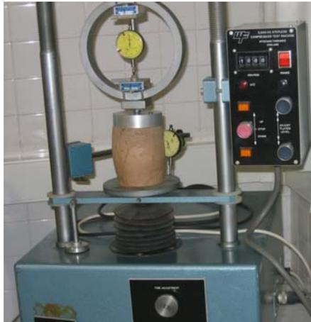
*Fig. 4 - Ensaio de compressão*
