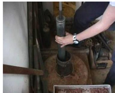
*Fig. 3 – Molde pequeno e pilão leve (ensaio Proctor)*
