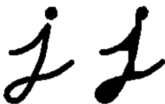
Figura 4.2 Abertura. Útil na remoção de pequenos buracos.
