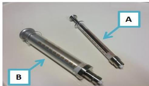
Figura 3.9 - Seringas em vidro com ligação *Luer Lock*; A-1 mL, B-10 mL
