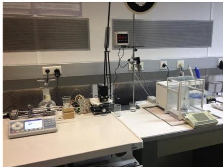
Figura 5.12 Padrão para medição de micro caudais entre 20 mL/h a 0,006 mL/h
