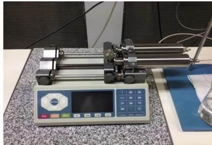
Figura 3.2 – Sistema gerador de caudal *Nexus 3000*
