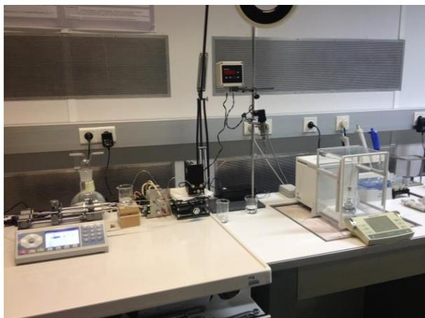
**Figura 3.21 – Padrão de medição de micro caudais entre 20 mL/h a 0,006 mL/h**
