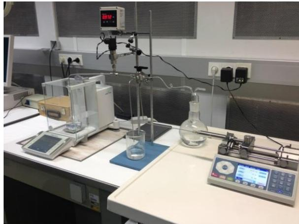
**Figura 3.22 – Padrão de medição de micro caudais entre 20 mL/h a 600 mL/h**
