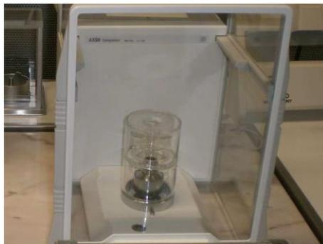
**Figura 5.14 - *Evaporation Trap* instalada na balança durante um ensaio de evaporação**
