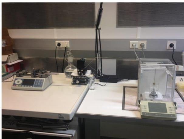
**Figura 3.13 – Instalação da válvula automática no padrão de medição de micro caudais**
