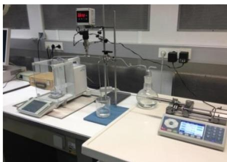
**Figura 5.13 - Padrão de medição de micro caudais entre 20 mL/h a 600 mL/h**
