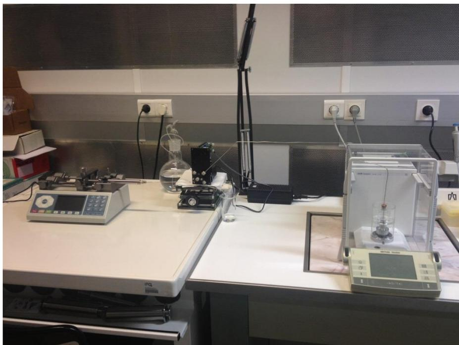
Figura II.1 - Padrão para medição de micro caudais, com válvula automática.
