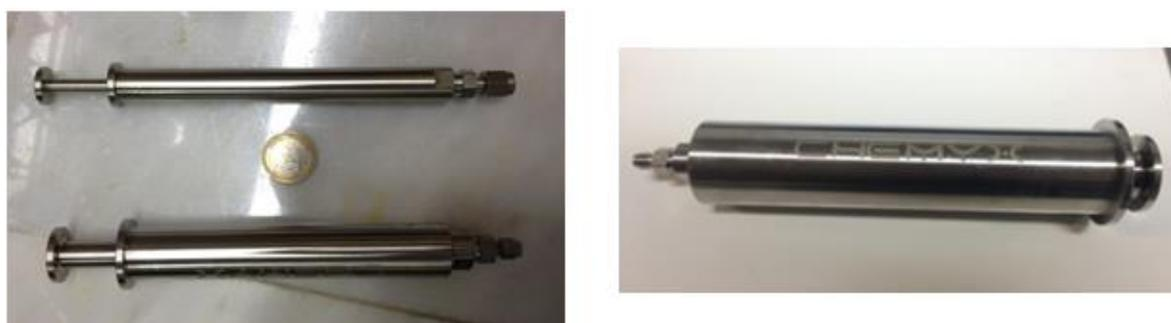
Figura 3.4 – Seringas em aço inox de 5 mL e 20 mL à esquerda e 100 mL à direita
