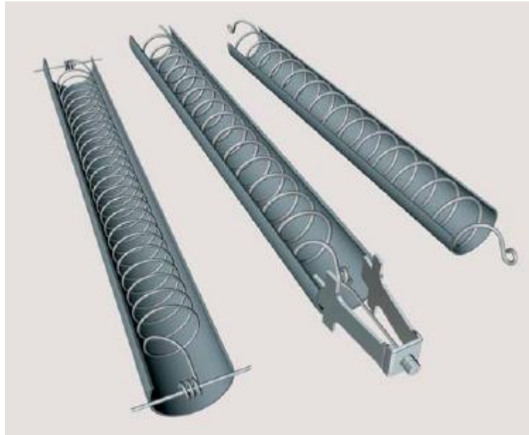
Figura 24 - Esquema dos tube inserts no interior do tubo de um permutador [13] .
