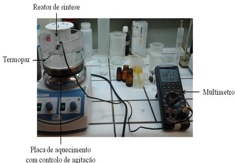
Figura 2.3 – Reator de síntese de nanobastonetes de ZnO com controlo de temperatura e agitação.
