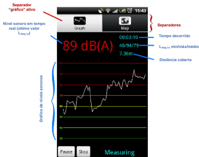
Figura 4.11 - Aplicação móvel NoiseTube Mobile durante uma medição (plataforma Android ) (Adaptado de Stevens, 2012)
