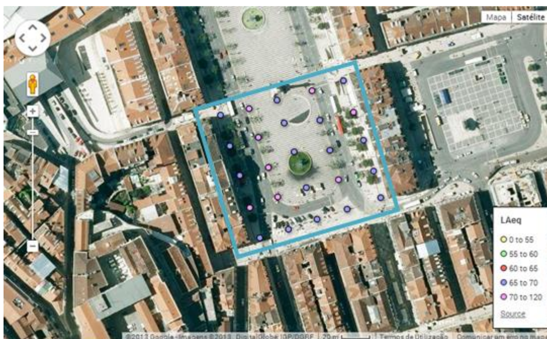
Figura 5.10 - Mapa de ruído na Praça do Rossio, com uma resolução de 20 x 20 metros e baseado em medições de cinco minutos
