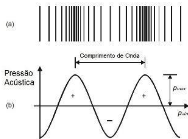
Figura 2.1 - Representação de uma onda sonora. (a) Compressões e rarefações geradas no ar pela onda sonora; (b) representação gráfica das variações de pressão, acima e abaixo da pressão atmosférica (Adaptado de WHO, 1995)
