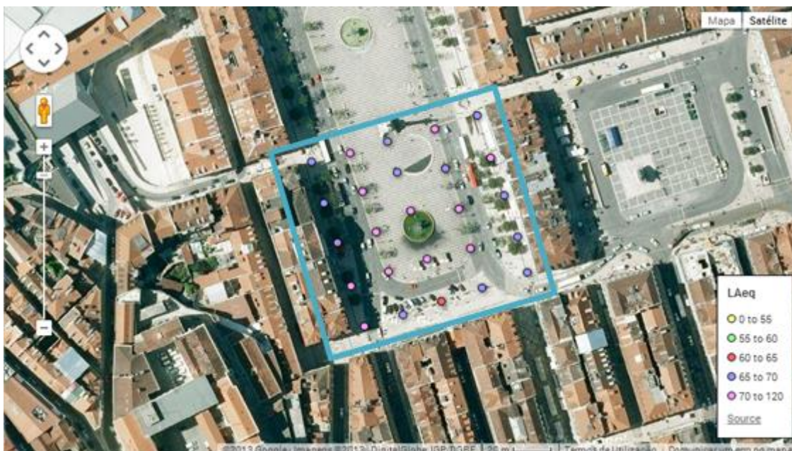
Figura 5.9 - Mapa de ruído na Praça do Rossio, com uma resolução de 20 x 20 metros e baseado em medições de um minuto
