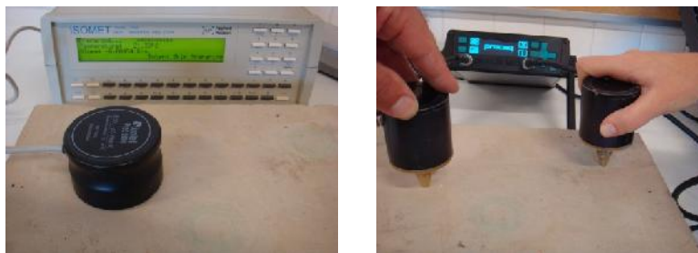
Figura 2: Ensaio de condutibilidade térmica (a) e de ultrassons (b)
