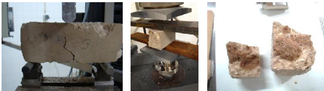
Figura 3: Ensaios de flexão (a), de compressão (b) e secções de rotura de um provete do betão C (c)
