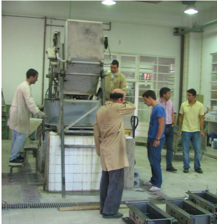
Figura 3.8: Fabrico do betão de barragens utilizado para moldagem dos provetes
