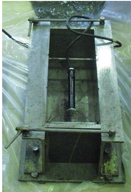
Figura 2.9: Extensômetro de resistência eléctrica tipo Carlson da marca “ KYOWA ELECTRONIC INSTRUMENTS CO., LTD. ” aplicado num molde
