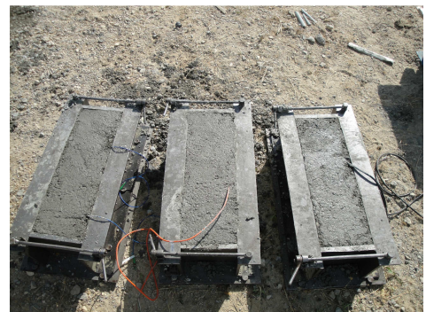
Figura 3.9: Moldagem dos provetes de betão de pontes em estaleiro
