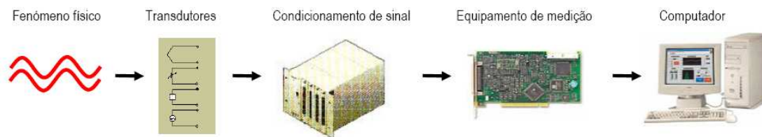
Figura 3.22: Esquema funcional de um sistema de aquisição automática baseado num computador pessoal [Serrano et. al. , 2004]
