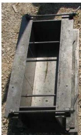
Figura 3.4: Molde metálico utilizado na construção dos provetes prismáticos
