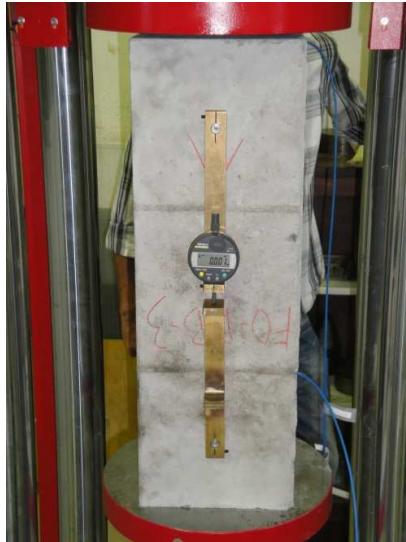
Figura 3.16: Deflectómetro aplicado numa das faces do provete
