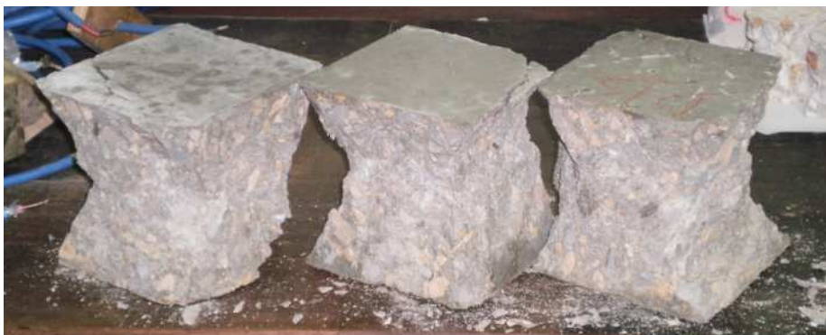
Figura 3.14: Aspecto das superfícies de rotura dos provetes cúbicos
