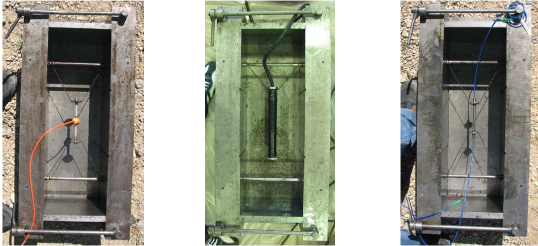
Figura 3.6: Posicionamento dos vários tipos de extensómetros nos moldes
