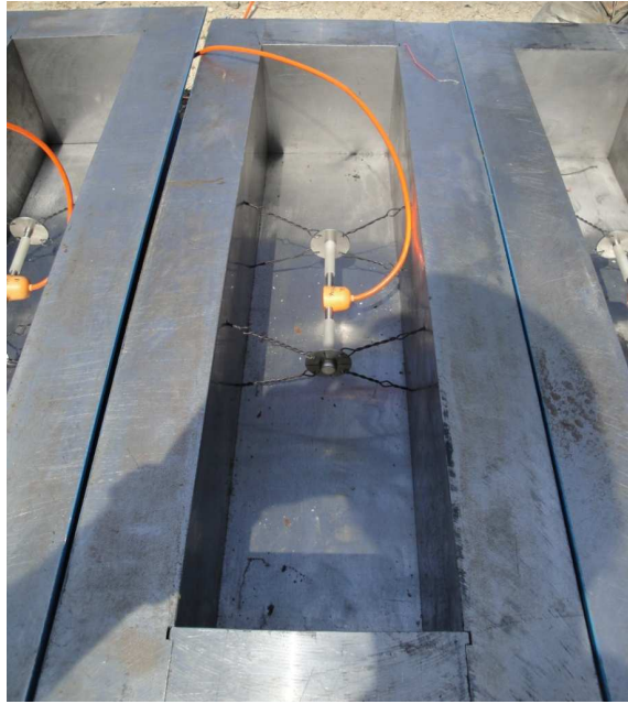
Figura 2.7: Extensómetro de corda vibrante da marca “ Gage technique International Ltd. ” aplicado num molde
