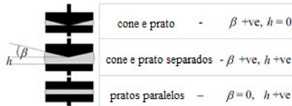
Figura 1.10 – Várias configurações para as geometrias cone e prato e pratos paralelos, utilizadas na medição das diferenças de tensões normais [adaptado de 1].
