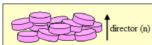
Figura 1.16 – Representação esquemática da organização molecular numa fase nemática discótica [12].
