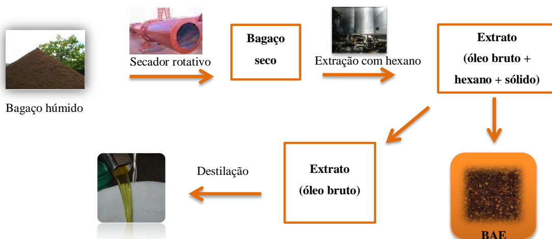
Figura 1.9 Esquema de recuperação de óleo a partir do bagaço de azeitona
