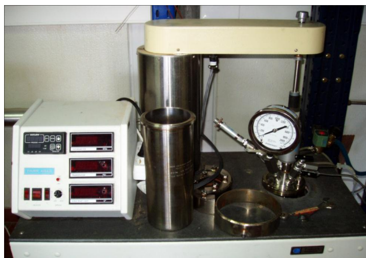
Figura 2.1 Equipamento utilizado para a realização dos ensaios de auto-hidrólise do BAE
