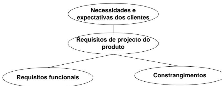
Figura 3.23 – Das necessidades e expectativas dos clientes à determinação dos requisitos funcionais e constrangimentos, segundo Otto e Wood (2001).
