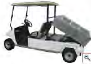
Veicolo Italcars elettrico 2 posti e cassone ribaltabile idraulicamente
